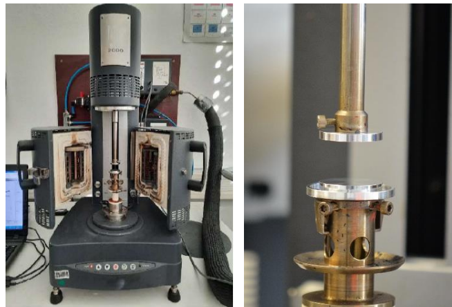
Abbildung 11: links: Rotationsrheometer AR2000ex der Firma TA Instruments; recht: Platte-Platte Geometrie
