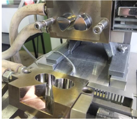
Abbildung 14: Messkammer des Brabender und verwendete Schaufelgeometrie
