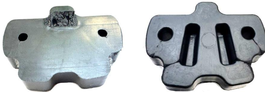
Abbildung 37: Fehlstellen an den vollständig gefüllten Bauteilen aufgrund einer unzureichenden Nadelkraft
