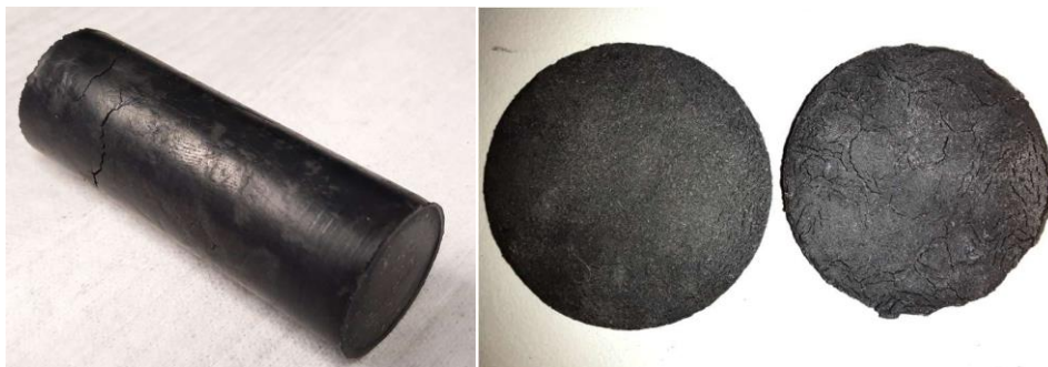
Abbildung 12: links: gepresster Zylinder, rechts: Aus Zylinder gefertigte Rheometerproben
