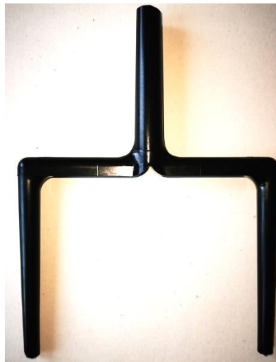
Abbildung 30: Bei der Reinigung des Werkzeugs entnommener Anguss
