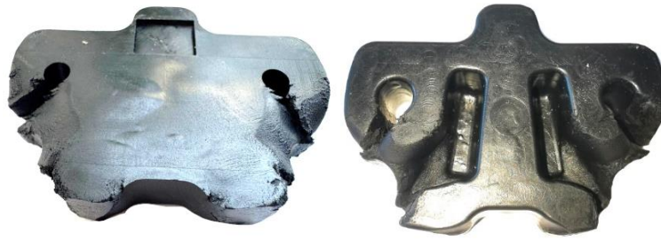
Abbildung 36: Unvollständig gefüllte Kavität aufgrund eines zu geringem Einspritzvolumens
