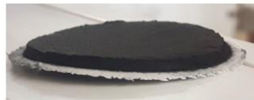
2 mm Pulveraktivkohle-Anschwemmsschicht auf Trägermaterial, Laborversuche (Bild: ISWW)
