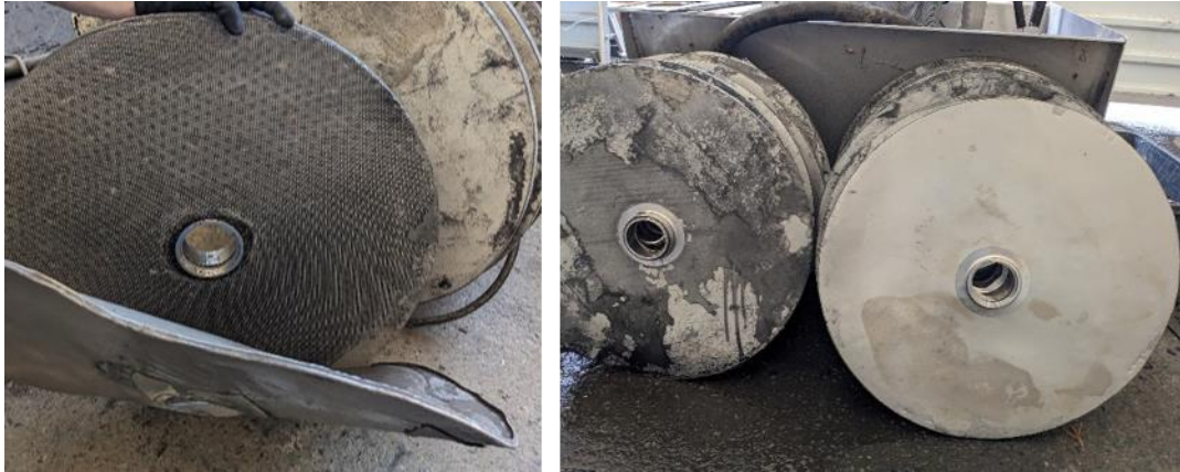
Abbildung 9: Linkes Bild: ausgebaute Filterscheibe mit Feinmesh auf Stützgewebe. Rechtes Bild: aus Filterkessel ausgebaute Filterscheiben (links), Hochdruck gereinigte Scheibe (rechts) (Foto: K. Bauerfeld, 2024)
