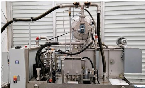
Anschwemmfilter Pilotanlage, bestehend aus Filterkessel und Sekundärfilter (Bild: Hoffmann Maschinen und Apparatebau GmbH)
