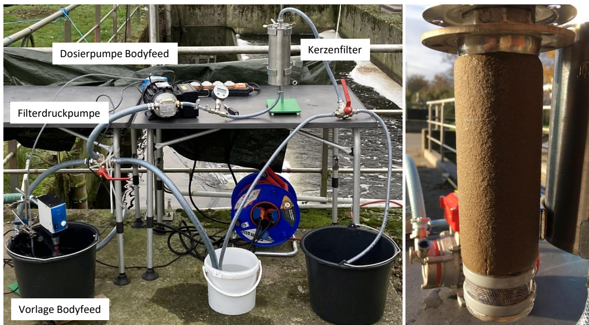
Abbildung 4: Links: Versuchsanlage für die Untersuchungen zur Anschwemmschicht, Rechts: Filterkerze mit Anschwemmschicht (Fotos: H. Geers, 2022)
