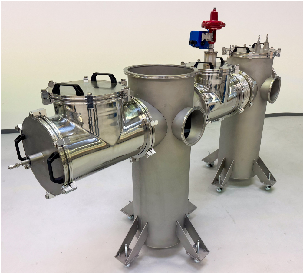
Abbildung 10: Vakuumkammer. Zur Reduktion der Wärmeeinträge in die kryogene Prozessstrecke durch Konvektion und Wärmeleitung der Luft werden der Gegenstromwärmeübertrager CF-HX 2, das Drosselventil und das LH2-Speichergefäß durch ein Hochvakuum isoliert. Die Vakuumkammer ist für einen Betriebsdruck von 10^{-5} mbar ausgelegt. In den beiden vertikalen Kammerteilen werden der Wärmeübertrager und das LH2-Speichergefäß aufgehängt. Das Drosselventil ist hier im Bild bereits eingesetzt.
