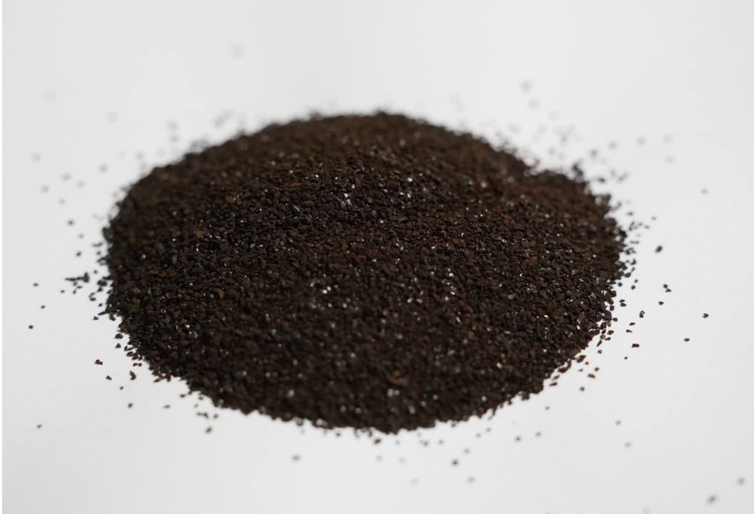
Abbildung 17: Eisen(III)-oxid als Katalysator der Ortho-Para-Umwandlung. Die katalytische Reaktion basiert auf paramagnetischen Wechselwirkungen zwischen dem Eisen(III)-oxid und dem Wasserstoffmolekül. Das hier gezeigte Eisen(III)-oxid-Pulver wurde von Ranido bezogen.
