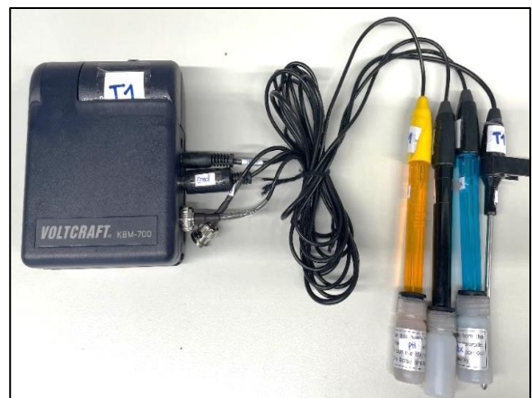
Abbildung 5. Darstellung der verwendeten Multimeter und der verschiedenen Elektroden.
