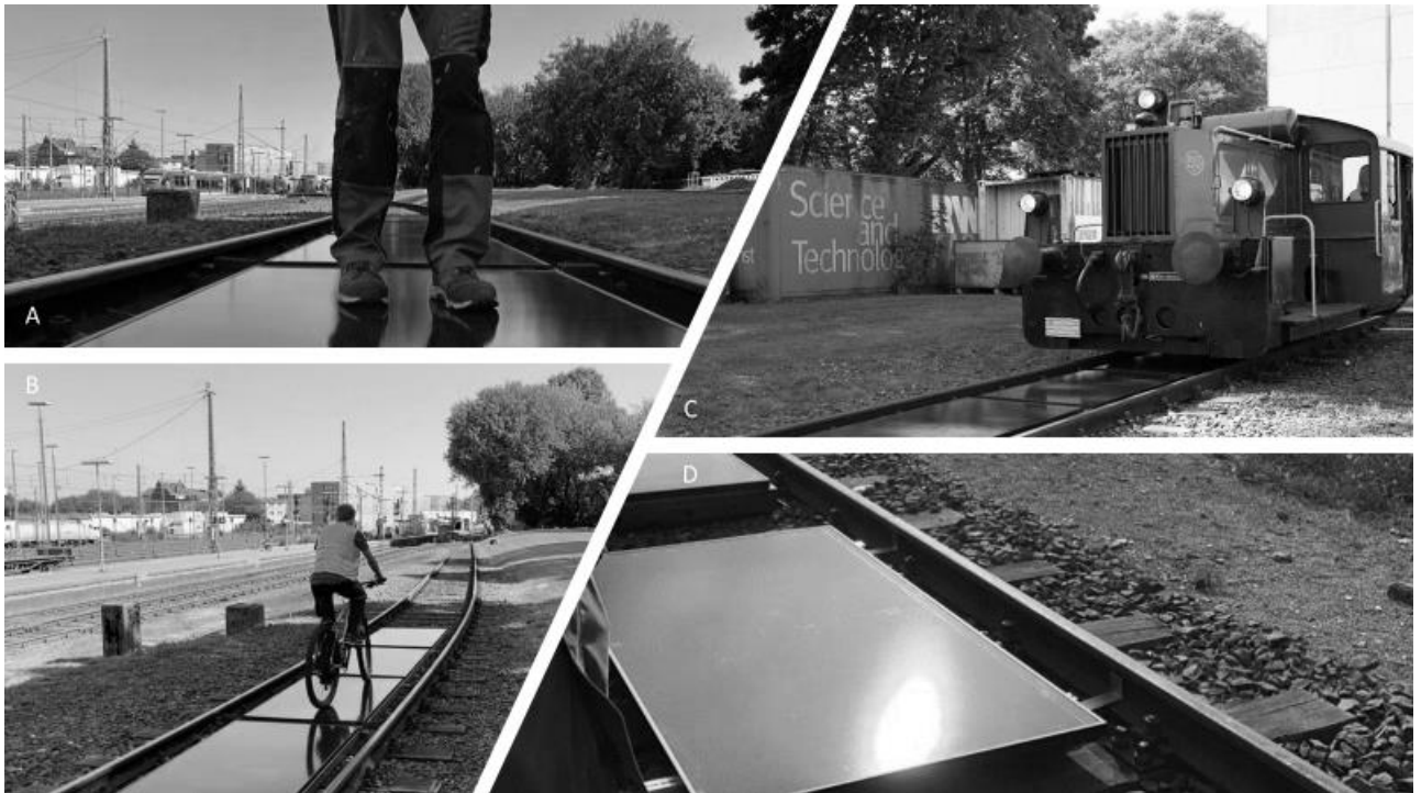
Abbildung 8: Tests im Reallabor. A: statische Belastung, B: dynamische Belastung, C: Überfahrt mit Rangierlock, D: Reflexion
