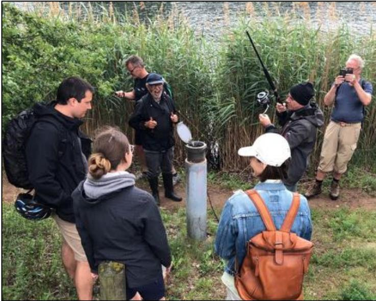
**Abbildung 29:** Beprobung einer Grundwassermessstelle mit dem Netzsammler: Um die Grundwassertiere zu fangen, wird ein Netz mit Hilfe einer Angel in die Grundwassermessstelle herabgelassen und anschließend wieder heraufgeholt. Foto: Prof. Dr. Christian Griebler, Universität Wien.
