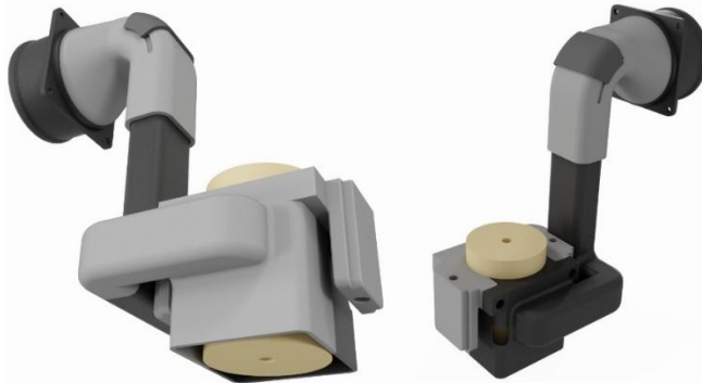
Abbildung 10: Quellenhalterung inklusive Absaugungskonzept.
