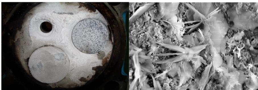
**Abbildung 1: links) Ablagerung von SiO<sub>2</sub> in einem mit Deponiegas betriebenen Gasmotor; (rechts) Rasterelektronenmikroskop-Aufnahme eines NiO-Katalysators mit SiO<sub>2</sub>-Plättchen belegten Oberfläche [1, 2]**
