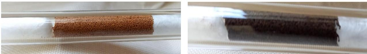
**Abbildung 13: Vergleich Eisen-oxo-Spezies FS vor (links) und nach (rechts) Adsorptionsversuch von H<sub>2</sub>S mit O<sub>2</sub> und zusätzlichem Wasser**
