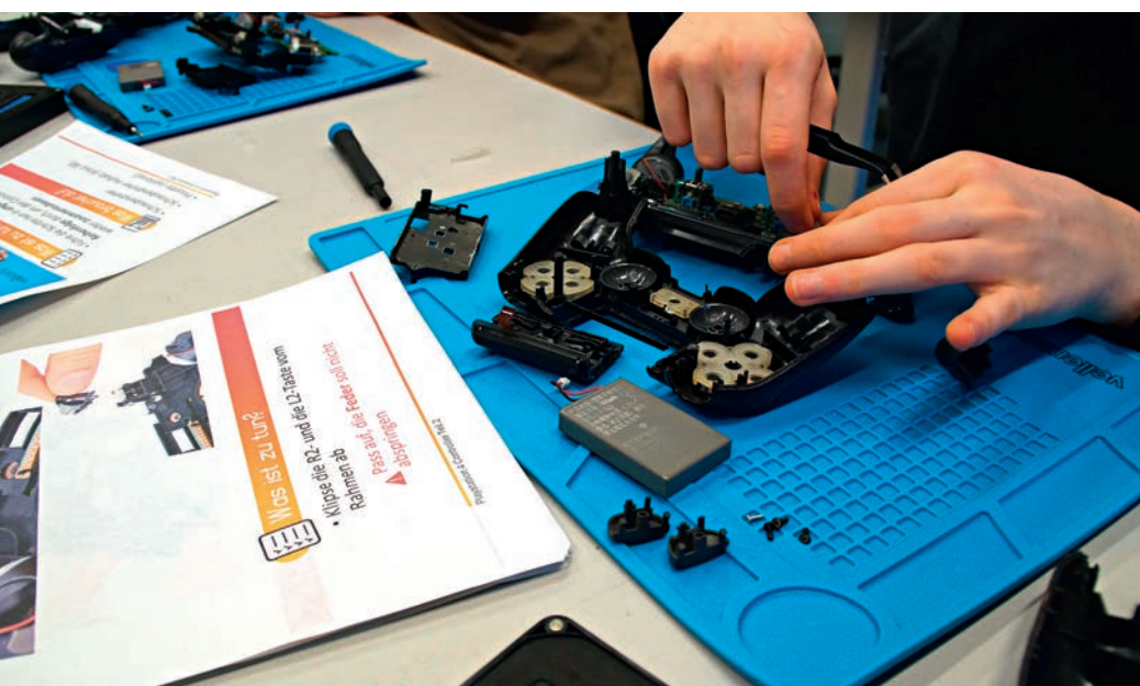
PS-Controller Akkutausch in der ATB Werkstatt der Uni Oldenburg mit SchülerInnen der 9. Klasse der OBS Bockhorn, Januar 2024.
