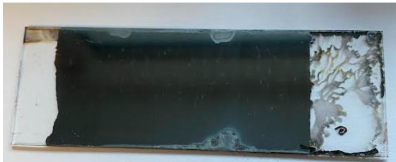
Abb. 8 – Fotografie eines mittels Schlitzdüsenbeschichtung hergestellten Perowskit-Films auf Glas mit einer Fläche von circa 5 cm x 2.5 cm ( 12.5 \text{ cm}^2 ). Die Scangeschwindigkeit betrug 30 mm pro Minute.
