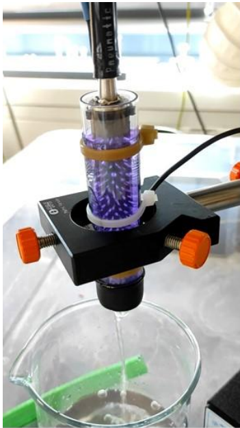
Abb. 4 Foto der dielektrischen Barriereentladung DBE-2 (links); schematische Darstellung der Plasmaerzeugung im Wasser nach Anschluss an einen Wasserhahn.[2]
