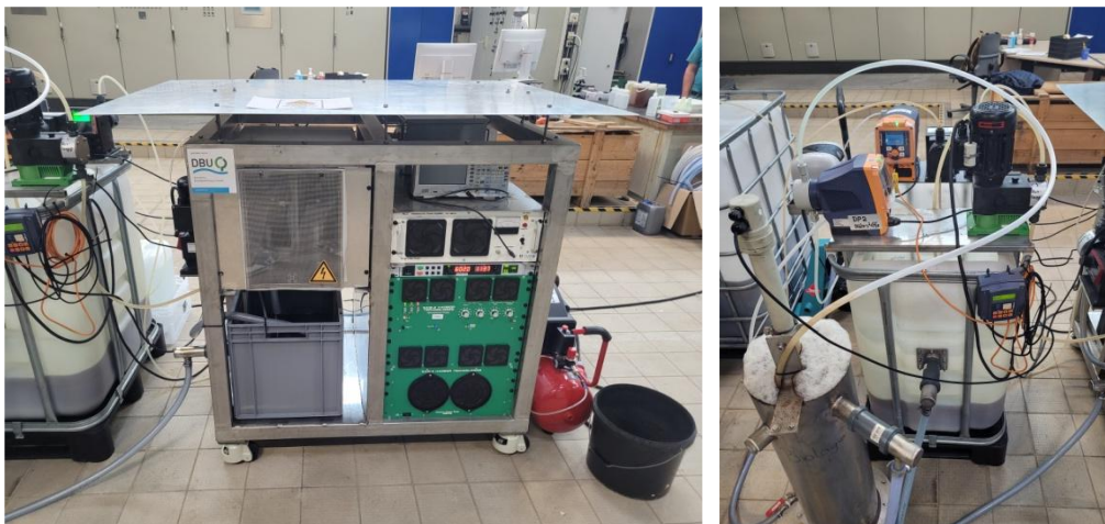
Abb. 22 Fotos der Dekontaminationseinheit beim Zweckverband Abfalltechnik Region Trier (A.R.T.; links) einschließlich Auffangbehälter (rechts).
