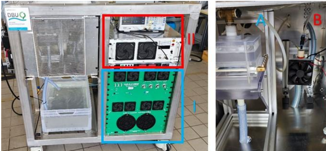
Abb. 6 Versuchsaufbau mit Abschirmbox und Hochspannungsversorgungseinheiten, I = Eagle Harbor Technologies Pulsgenerator/ II= Amp-Line Versorgung mit Transformator und Funktionsgenerator (links); Blick in die Abschirmbox, A = Plasmaquelle DBE-1, B = Plasmaquelle DBE-2 (rechts).
