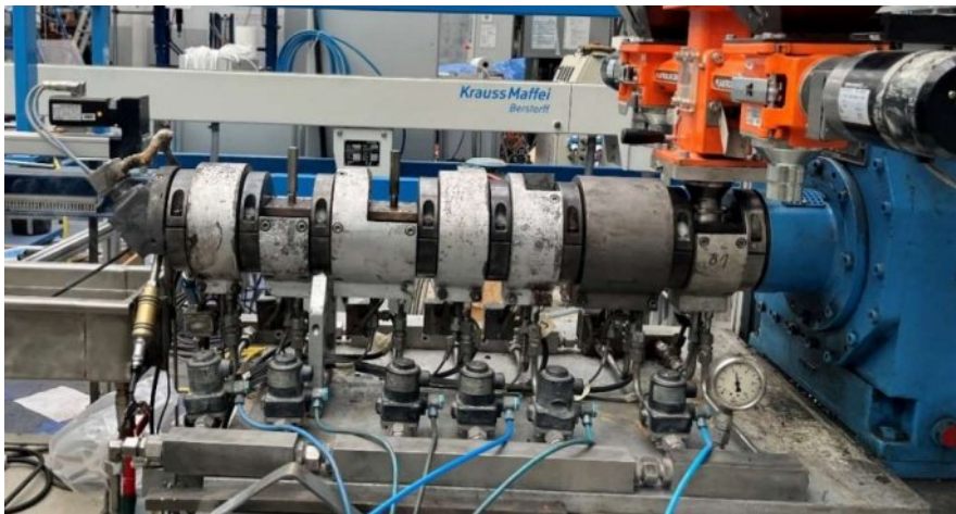
Abbildung 14: Doppelschneckenextruder im Labormaßstab zur Herstellung der Mischmaterialchargen
