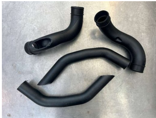
Abbildung 4: PIA Versuchsbauteile für Recyclingversuche (PA6 und PA66)
