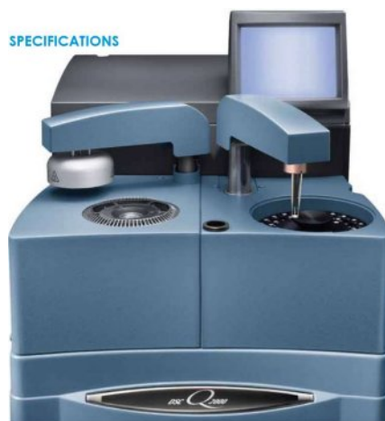
Abbildung 8: Dynamisches Differenzkalorimeter Q2000 [16]
