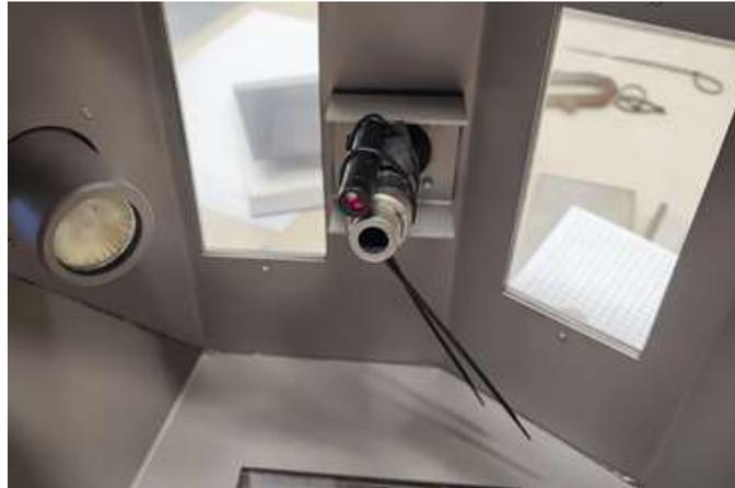
Abb. 27: Laserpointer mit provisorischer Befestigung an der Strahldüse, Blick aus Richtung Objekt in die Arbeitskammer
