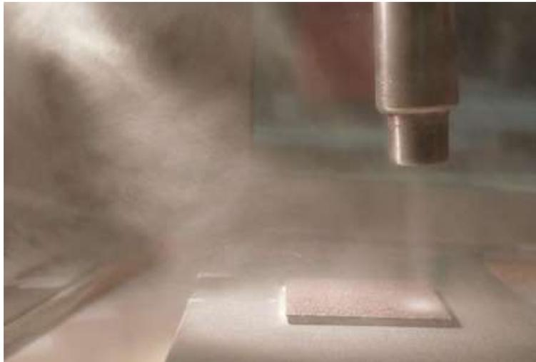
Abb. 39: Blick in die Bearbeitungskammer während der Reinigung. Deutlich zu sehen ist der gerichtete Strahl des Strahlmittels, der durch das Vakuum aus der Düse gezogen wird und das Probestück trifft. Gleichzeitig wird das Absaugen von Strahlmittel und abgereinigten Partikeln sichtbar.
