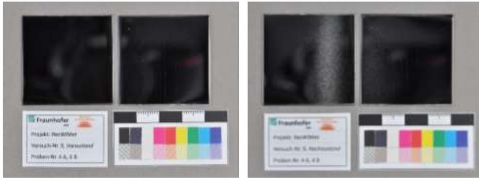
Abb. 19: Fotodokumentation der polierten Probekörper A und B vor (links) und nach (rechts) der Bestrahlung
