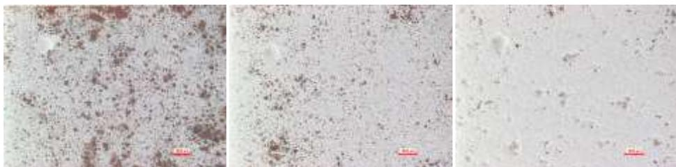
Abb. 13: Unterschiedliche Bearbeitungsqualitäten mit Asilit AS 180: (v.l.n.r.) Zustand 4 (Probe 61), Zustand 5 (Probe 64), Zustand 6 (Probe 69) ( Mikroskopaufnahmen: T.Lorenz)
