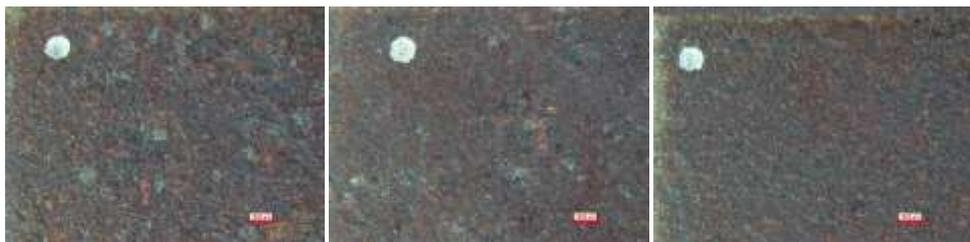
Abb. 12: Probenoberflächen der Kategorie Nr. 4 nach Behandlung mit Nusschalen NS 450 und unterschiedlichen Parametern (Proben 31, 34 und 39 - v.l.n.r.) Mikroskopaufnahmen: T.Lorenz
