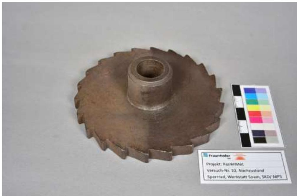
Abb. 38: Das Sperrrad, ein typisches Bauteil einer historischen Turmuhr, welches für die Demonstrationsversuche verwendet wurde. Deutlich unterscheiden sich die bearbeitete Fläche (rechts) von der unbearbeiteten (links).
