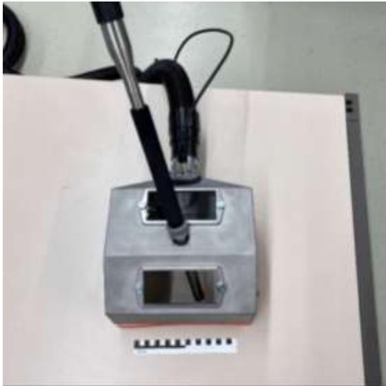
Abb. 3.: Äußerer Aufbau der Bearbeitungskammer mit Sichtfenstern und montierter Strahl-
