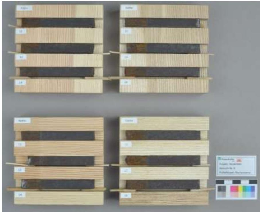
Abb. 23: Metall-Holz-Probekörper nach der Bearbeitung. Das linke Viertel der Eisenprofile war abgedeckt und zeigt den korrodierten Vorzustand zum Vergleich.
