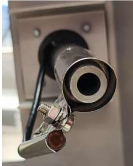
Abb. 32: Endoskopkamera mit einer justierbaren Befestigung an der Strahldüse
