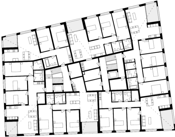
Abbildung 26: Abstellräume am Treppenhaus von Müller Sigrüst Architekten. Haus D im Hunziker-Areal, Zürich. Quelle: Müller Sigrüst Architekten.
