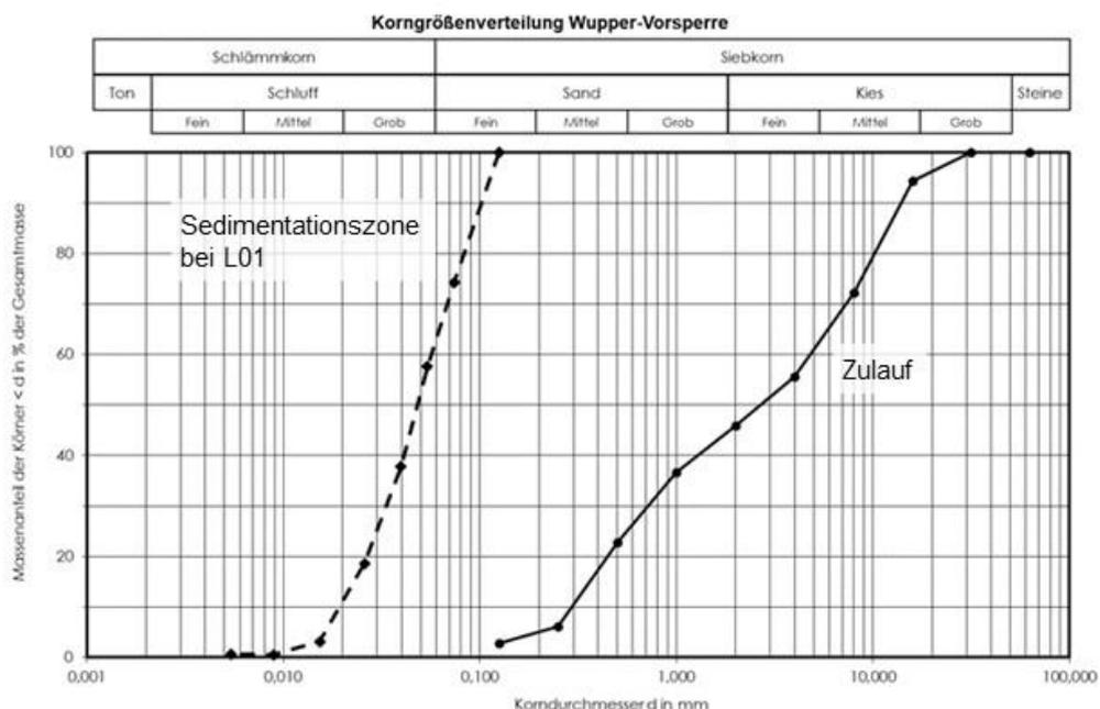
Abbildung 7: Korngrößenverteilung zweier Sedimentproben aus der Wupper-Vorsperre
