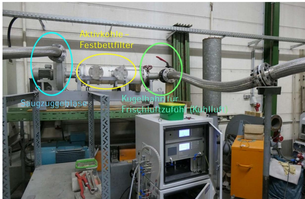
Abbildung 14: Anlagenausschnitt: Abgasleitung und -messung
