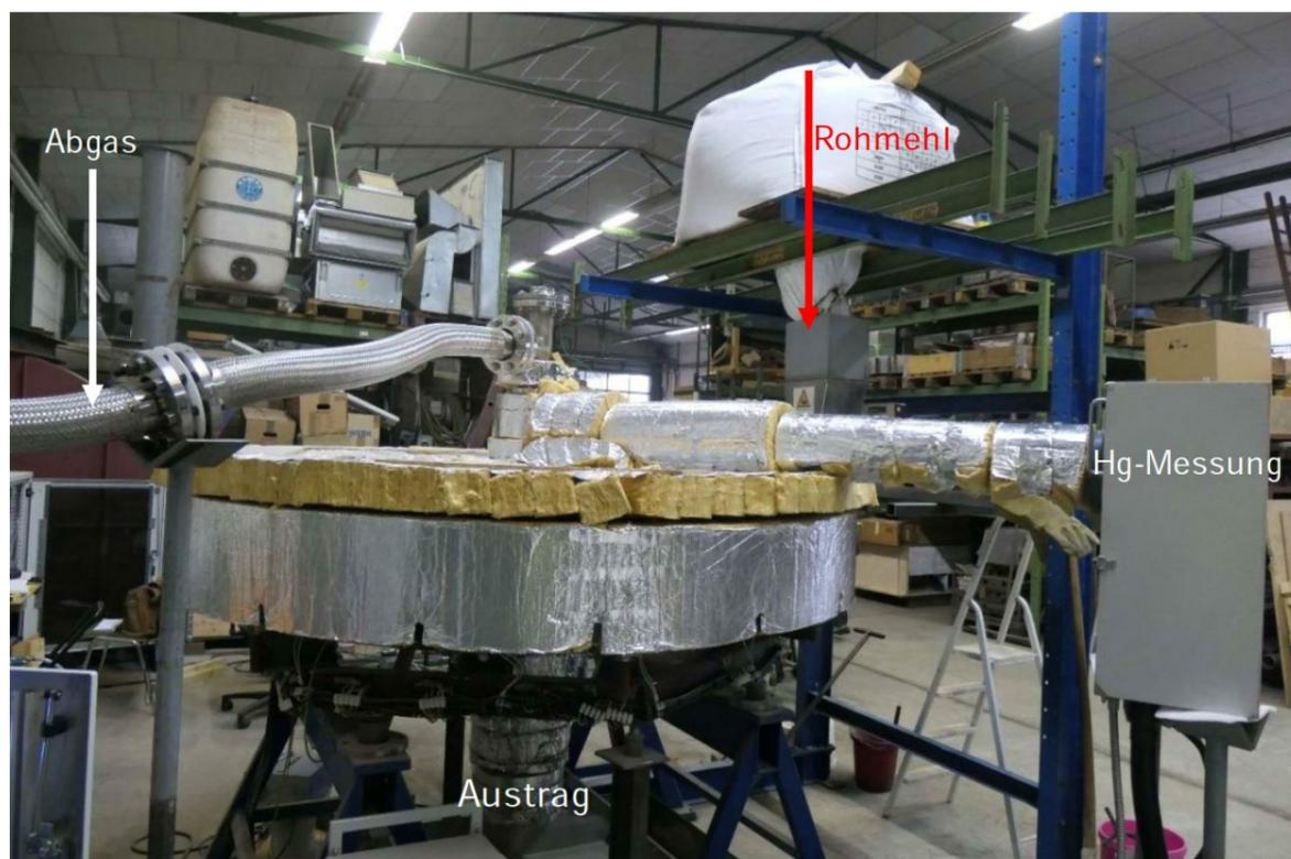
Abbildung 8: Ofen betriebsbereit, mit Isolierung, Abgasreinigung und Hg-Messeinrichtung
