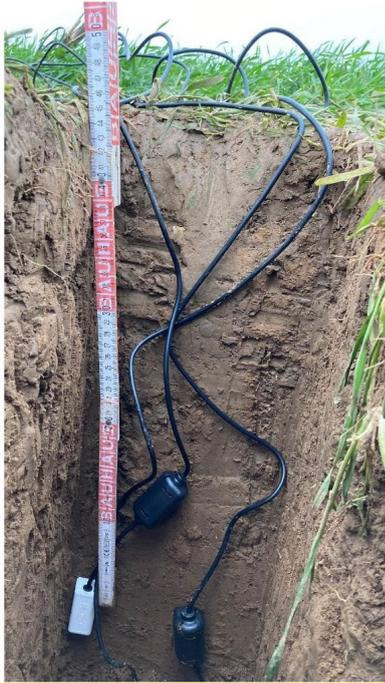
Abbildung 3: Einbau Bodenfeuchtesensoren in Darstadt
