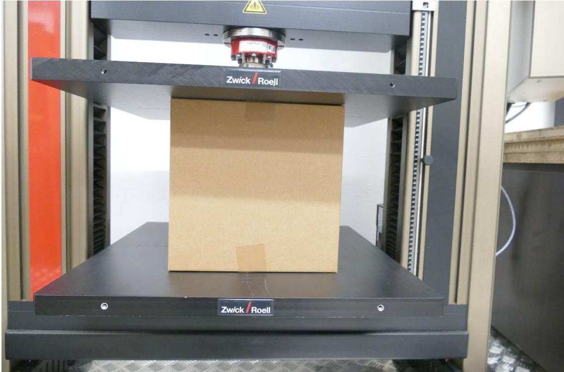
Abb. 14: Prüfaufbau Box compression test - exemplarisch
