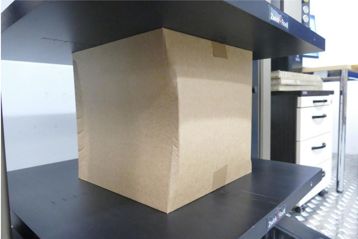
Abb. 15: Faltschachtel am Ende der Prüfung Box compression test (BCT) - exemplarisch
