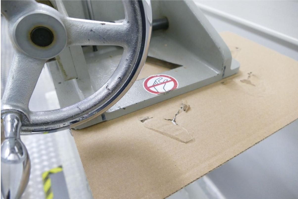
Abb. 10: Prüfaufbau Durchstoßarbeit Detail – Fokus auf Wellpappe
