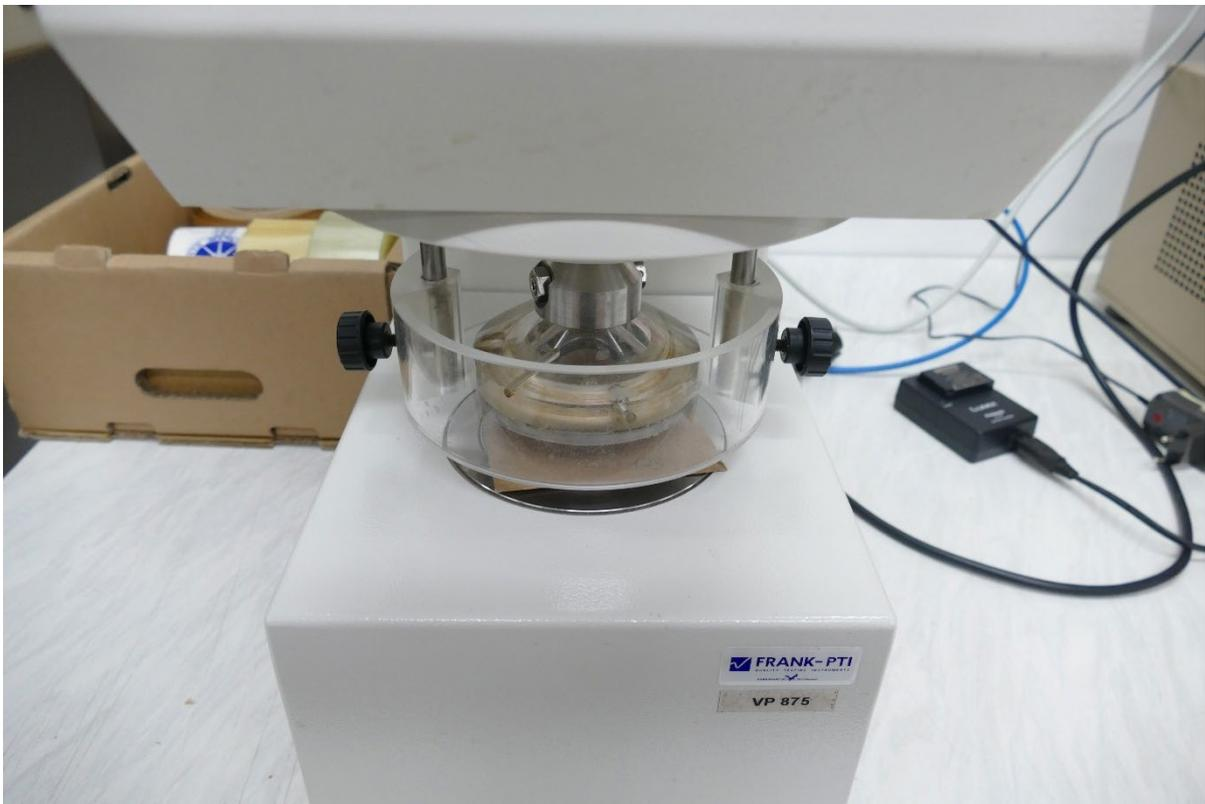
Abb. 11: Prüfaufbau Berstfestigkeitsprüfung
