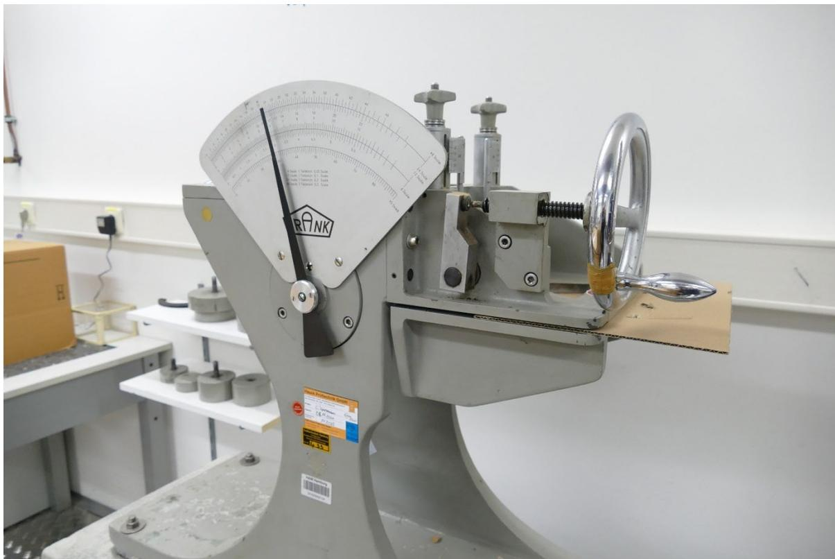
Abb. 9: Prüfaufbau Durchstoßarbeit Übersicht
