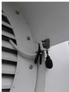
Abbildung 4: Installationsort des Mikrofons bzw. der Noisy.Blade Messtechnik in Relation zur Gesamtanlage.
