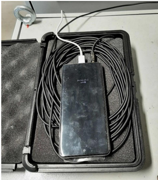
Abbildung 3: Die im Projekt genutzte Messtechnik besteht aus einem Smartphone mit Datenerfassungssoftware, welches mit dem außen am Turm befestigten Mikrofon verbunden ist. Zum Schutz gegen Umwelteinflüsse ist das Smartphone in einem Schutzkoffer untergebracht.
