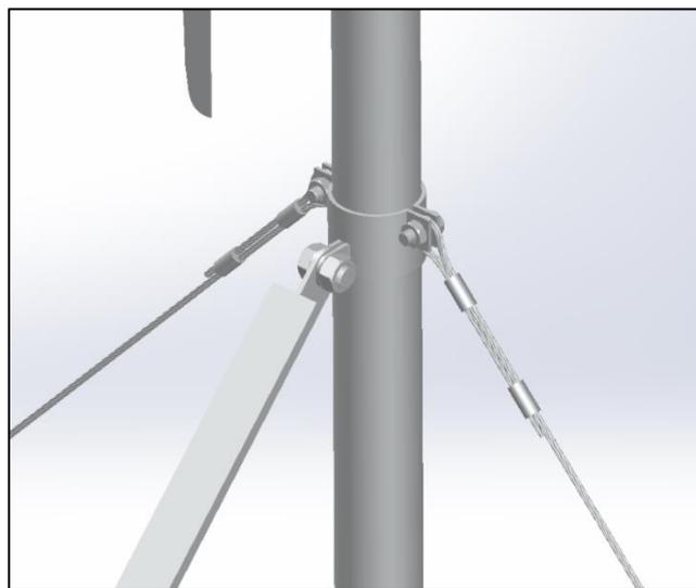
**Abbildung 40: Abspannung Rohr Mast WKA**
