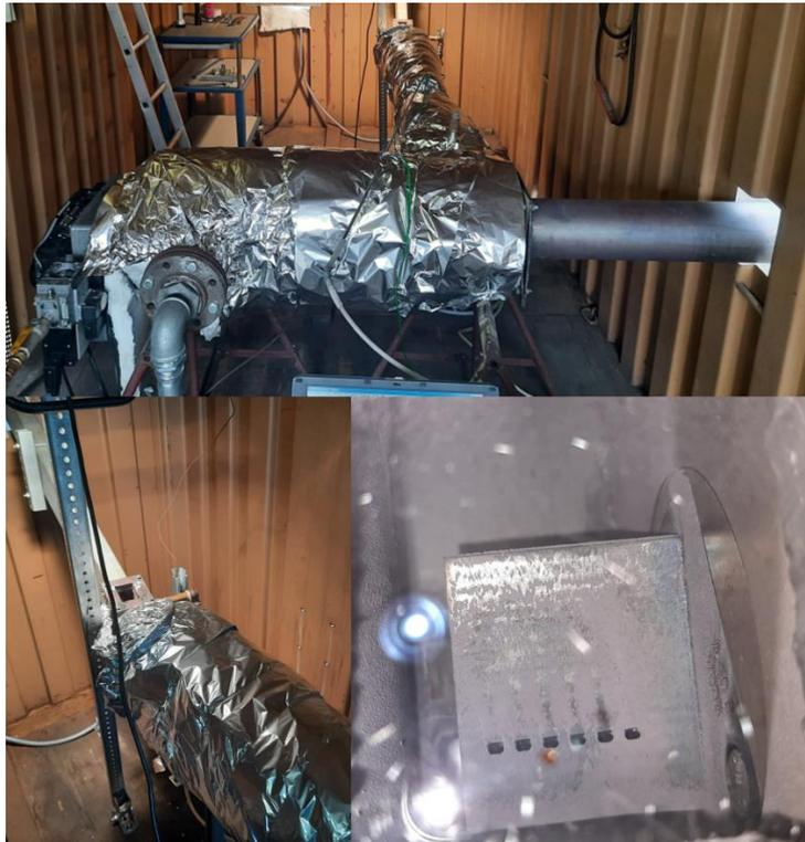
Abbildung 24 Erichteter Versuchsstand mit Darstellung des Schaufeleinsatzes
