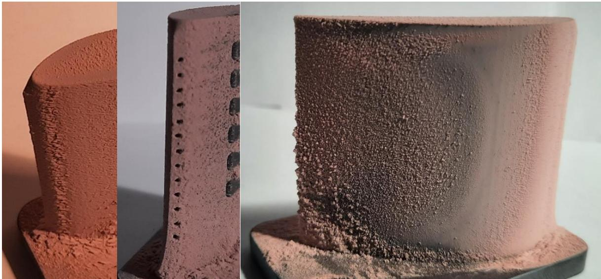
Abbildung 31 Vorderkante der Testschaufeln mit und ohne Frontalbohrungen sowie repräsentative Saugseite der Testschaufeln
