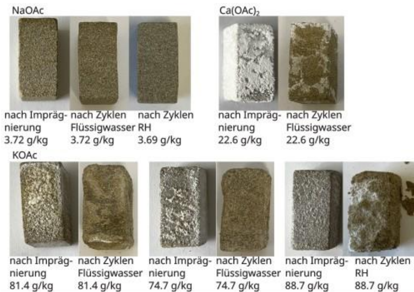
Abb. 62: Exemplarische Aufnahmen der Prüfkörper nach der Imprägnierung und nach den verschiedenen Zyklen mit NaOAc, Ca(OAc) 2 und KOAc
