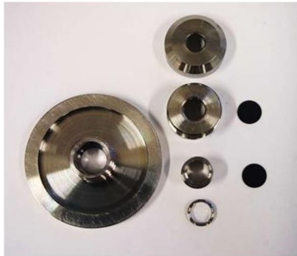
Abb. 4: Entwickelter Filteradapter für den Sartorius Trichter bestehend aus Platte, Töpfchen, O-Ring, Adapter für zweite Filterstufe und Abschluss-Adapter
