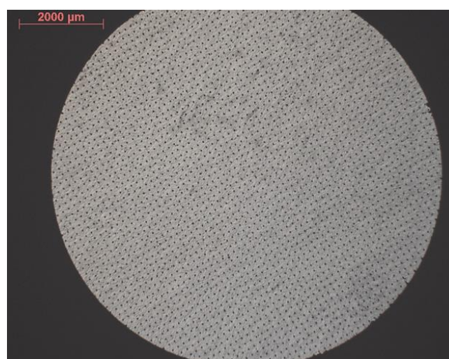
Abb. 9: Bild eines laserstrukturierten Silizium-Wafers (Porenabstand 150 \mu\text{m} , Porendurchmesser 50 \mu\text{m} , Membrandicke 500 \mu\text{m} )
