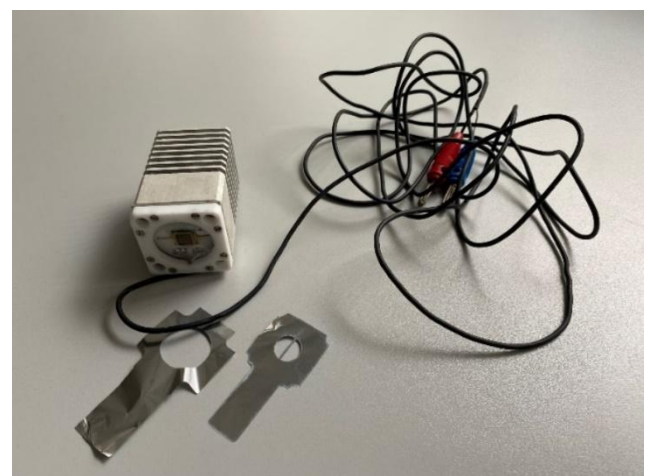
Abb. 7: F&E photoelektrochemische Ätzanlage, bestehend aus einer Ätzzelle mit Reservoir (links) und einer LED-Lampe (rechts)
