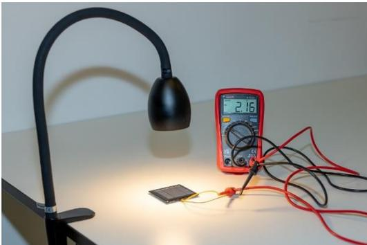
Abbildung 6: Experiment Photovoltaik - Messung Leerlaufspannung und Kurzschlussstrom
