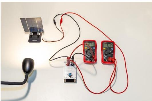
Abbildung 8: Experiment Photovoltaik - U-I-Kennlinie
