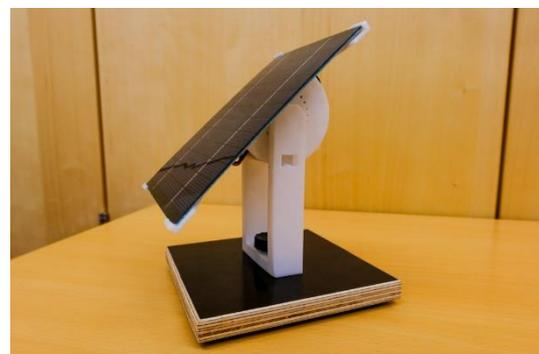
Abbildung 11: Experiment Photovoltaik - Halterung mit einstellbarem Neigungswinkel
