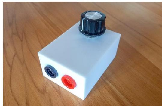
Abbildung 9: Experiment Photovoltaik - variabler Verbraucher (Potentiometer)
