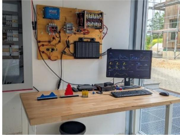
*Abbildung 5: Wechselrichter, Batterie und HEMS im Haushaltslabor*
