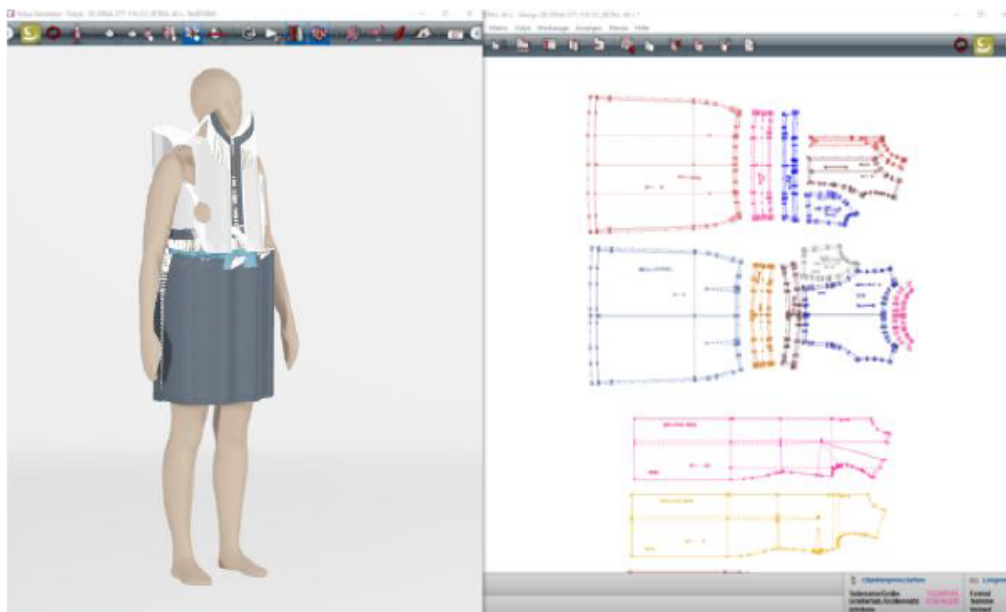
Abbildung 21: Schnittteile eines Kleides im CAD (rechts) vorpositioniert um den Avatar in 3D (links)
