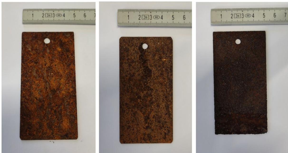
**Abbildung 36: Blechproben aus unlegiertem Baustahl mit Oberflächenkorrosion in verschiedenen Stadien.**
