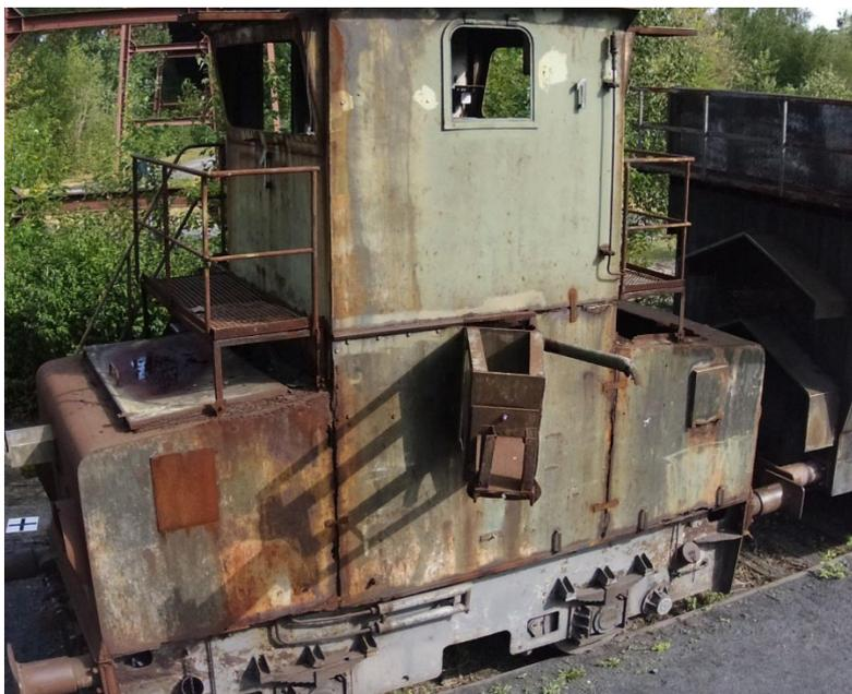
**Abbildung 1: Lösch-Lokomotive auf der Kokerei Zollverein. Diverse typische Schäden sind erkennbar: intakte Beschichtung, Lackabplatzungen, aktive und inaktive Korrosion, Kantenkorrosion, etc. Roter Rahmen: Bereiche von Interesse.**
