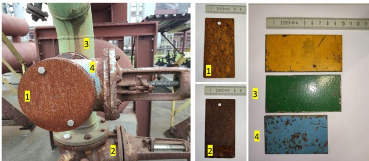
**Abbildung 32: Übertragung der identifizierten Korrosionsmechanismen am Beispiel HD-Einheit, Zollverein Essen.**
