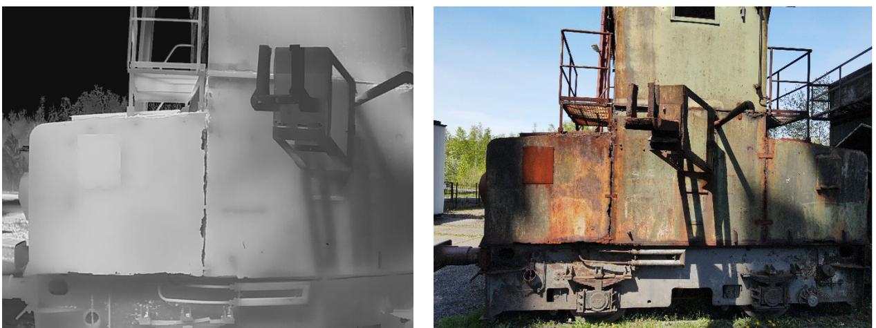
**Abbildung 25: Thermalbild (links) und RGB-Bild (rechts), aufgenommen am 03.05.2023.**
