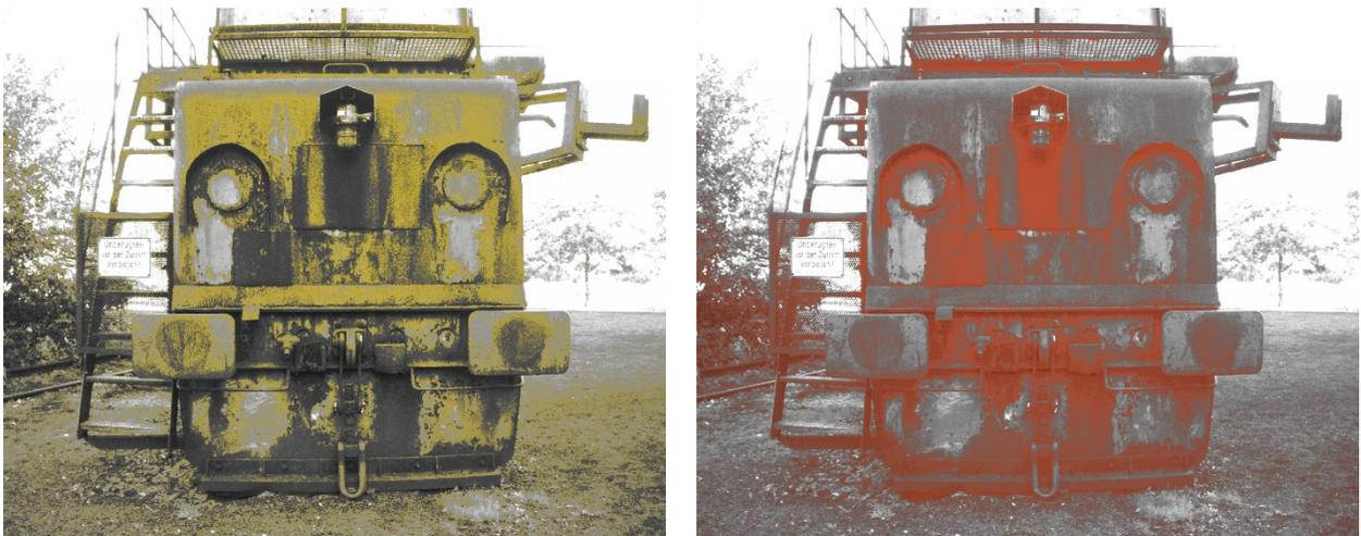
**Abbildung 39: Materialschäden im Farbspektrum: Oben links Zusammenfassung von unterschiedlichen Korrosionserscheinungen (aktive, ruhende Korrosion). Oben rechts: Intakte Coatings; Unten links: Flächenkorrosion (geschädigte Coatings); Unten rechts: Aktive Spaltkorrosion.**
