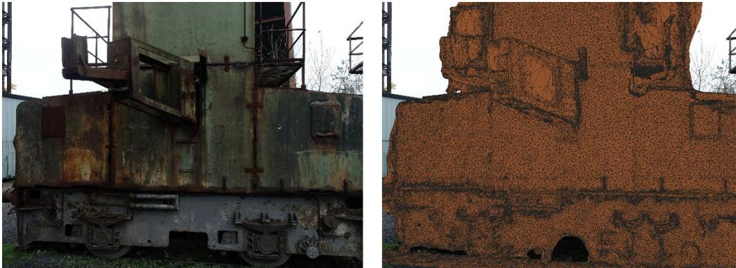
**Abbildung 21: Bildausschnitt (links) und ins Bild projizierte dreiecksvermaschte Oberfläche der Löschlok (rechts).**
