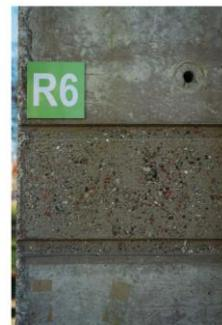
Bilder von der Musterbude von OTTO WULFF bei der verschiedene Recycling-Betons testweise verbaut wurden; © MiguelFerrazAraújo
