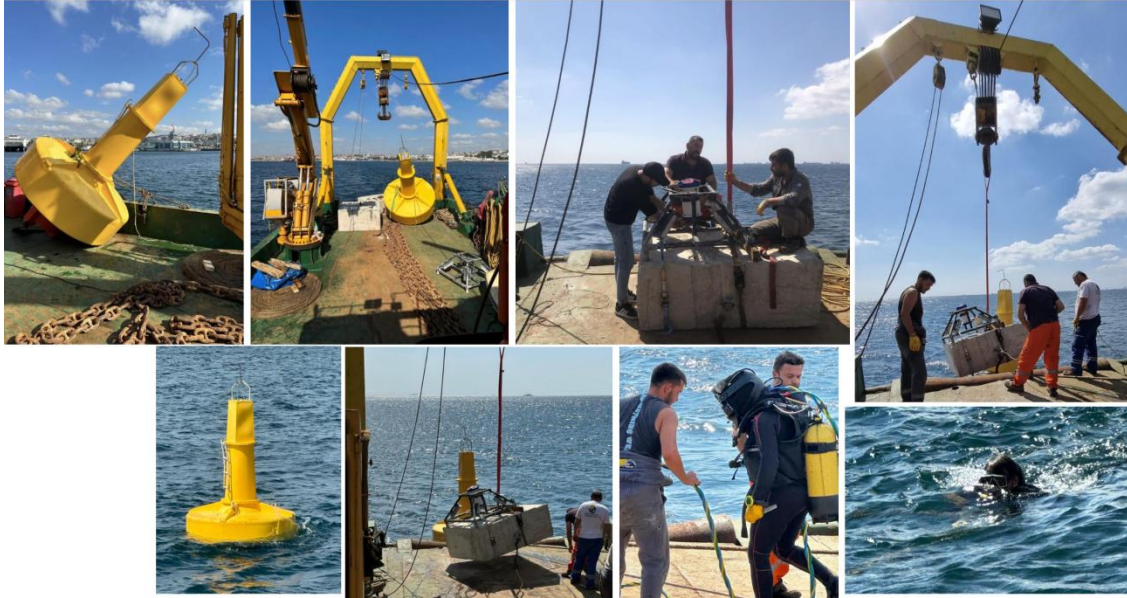
Abbildung 3. Einsetzen der Messstation.
