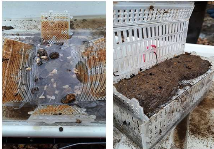
Abbildung 32: Brutboxen der Probestelle Ei-60-A-2022 (Eifgenbach) am Ende des Expositionszeitraums. Links: Eine der geborgenen Whitlock-Vibert-Boxen mit rostiger Verfärbung wies einen Bruterfolg von 0 % auf. Rechts: Die andere Box wies trotz hoher Sedimentfracht einen sehr hohen Bruterfolg auf.
