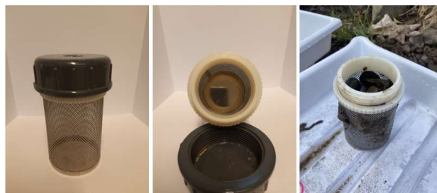
Abbildung 7: Aufbau der Filterkorb-Brutbox. Links: verschlossene Filterkorb Brutbox mit Deckel; Mitte: Filterkorb-Brutbox ohne Kieseinlage, mit Eiern; Rechts: Filterkorb-Brutbox mit Kieseinlage.
