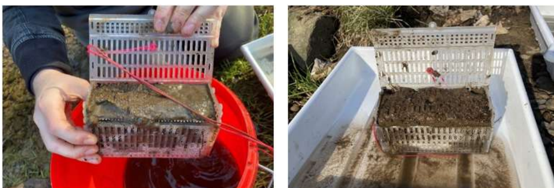
Abbildung 12: Geborgene Whitlock-Vibert-Box am Ende des Expositionszeitraums.
