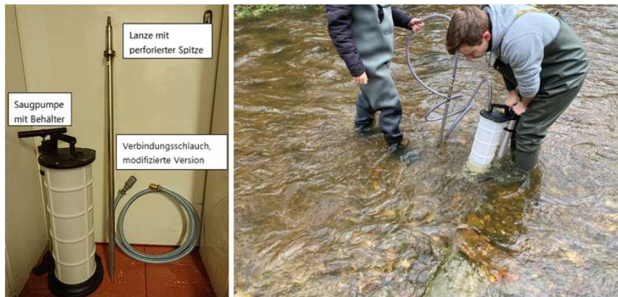
Abbildung 3: Bestandteile des Interstitialsamplers mit Lanze, Pumpe und Schlauch in der aktuellsten Ausführung.
