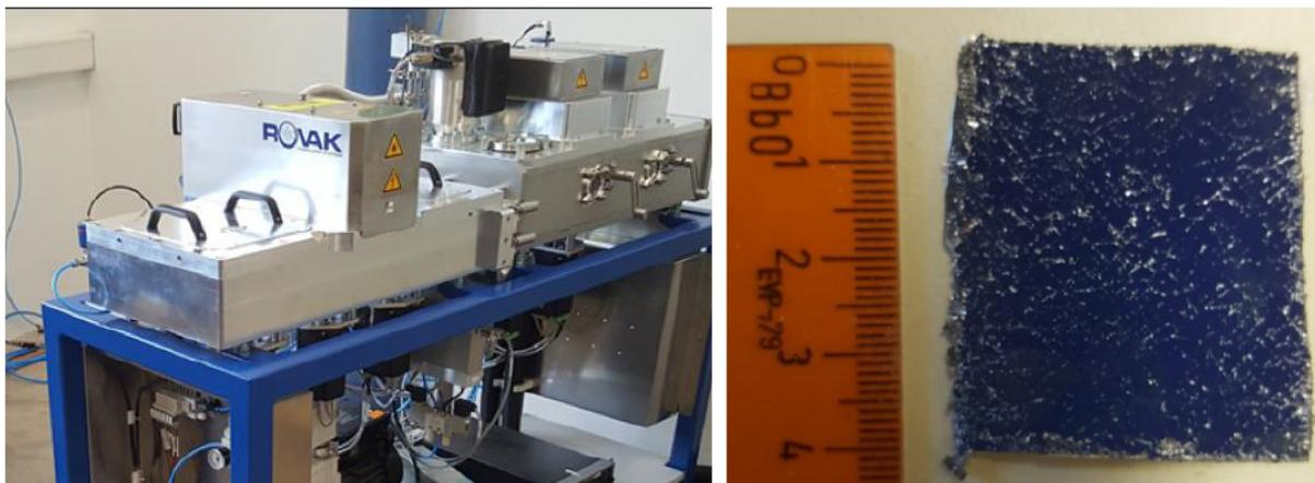
**Abbildung 4: Laboranlage der Rovak GmbH zur Behandlung der Solarmodul-Fragmente (links) und freigelegte Zelloberfläche (rechts).**
