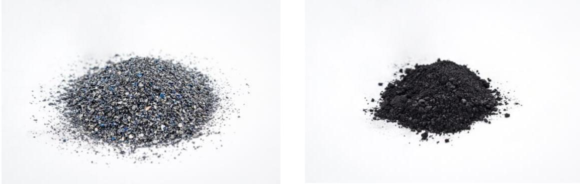
**Abbildung 17: Ausgangsprodukte für die durchgeführten Pelletierungsversuche. Links: Solarzellschrott. Rechts: Silizium Kerf**
