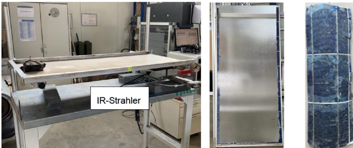
**Abbildung 9: Versuchsaufbau zur Erprobung der Delamination mittels IR-Strahlung (links), delaminiertes Solarmodul und das verbleibende Solarglas (mittig) und das abgelöste Laminat bestehend aus Rückseite, Zellen und EVA-Folie (rechts).**
