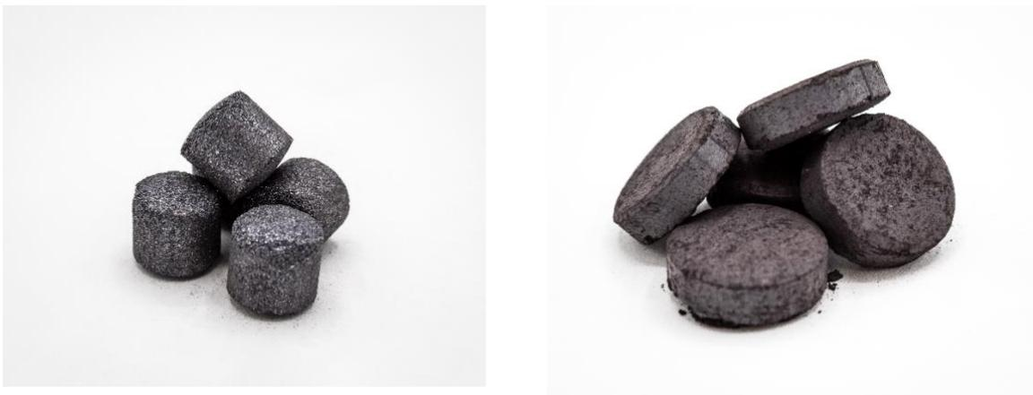
**Abbildung 18: Gepresste Pellets aus den beiden Ausgangsprodukten. Links: Solarzellschrott. Rechts: Silizium Kerf.**
