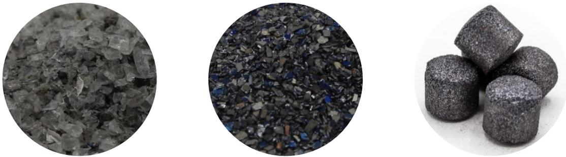
**Abbildung 15: Abbildung 6: Zerkleinerte Solarmodule (links) mit einem Siliziumanteil von ca. 10%, aufbereitetes Silizium-Pulver mit mehr als 98% Silizium (Mitte) und gepresste Silizium-Pellets (rechts).**
