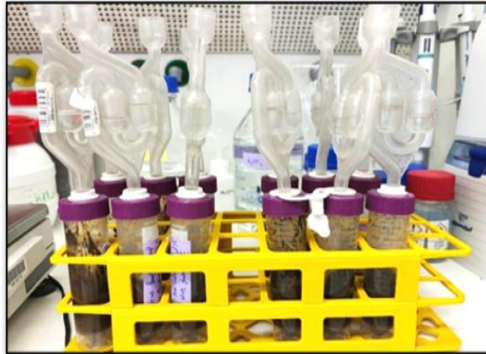
Abbildung 27: Versuchsaufbau zur Untersuchung des Abbaus pharmazeutischer Rückstände durch die LAF
