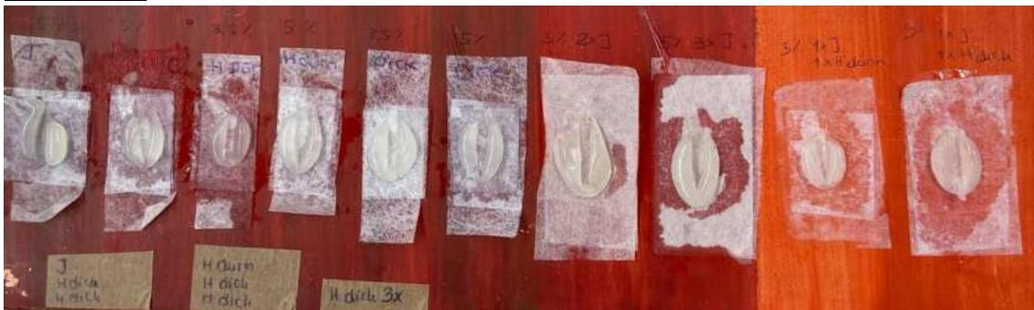
Abb. 3: Probekplatte 1 mit unterschiedlichen Papieren und Geweben und Heißklebertropfen
