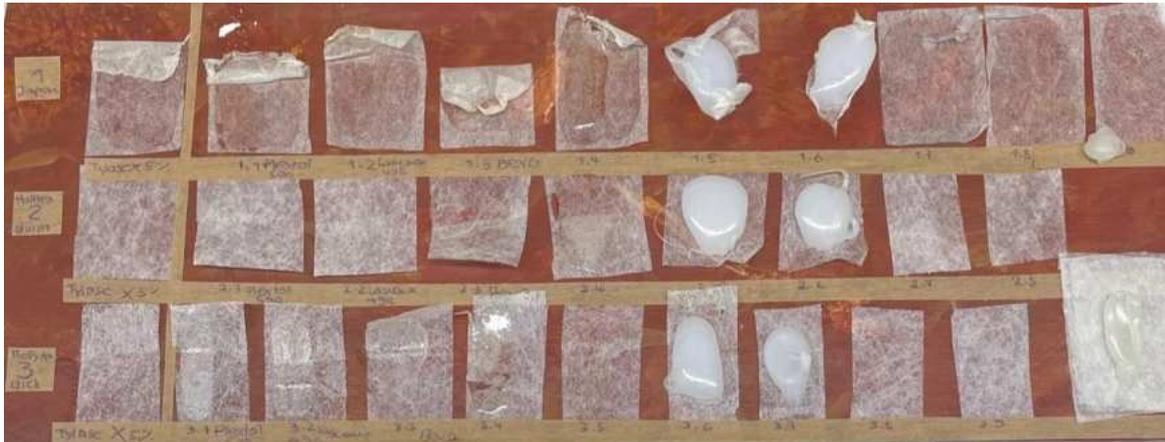
Abb. 1: Probekörper 2 mit unterschiedlichen Papieren und Geweben und Heißklebertropfen:
