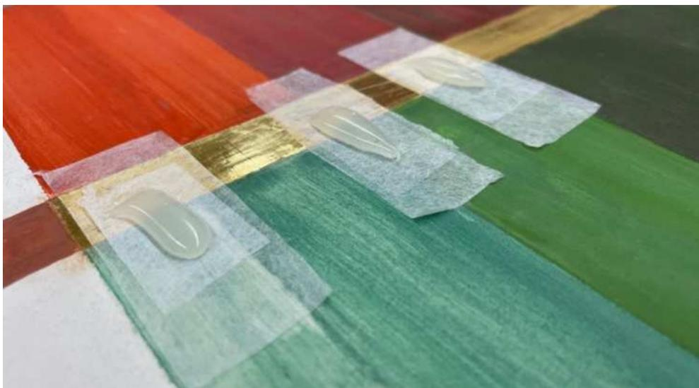
Abb. 4: Probeplatte 1 mit unterschiedlichen Papieren und Geweben und Heißklebertropfen
