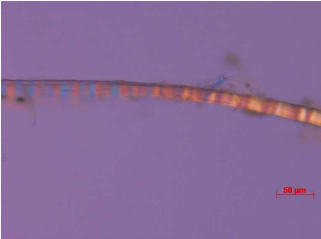
Abb. 12: Mikroskopaufnahme unter polarisiertem Licht bei 20-facher Vergrößerung von PW2 Probe 3.
