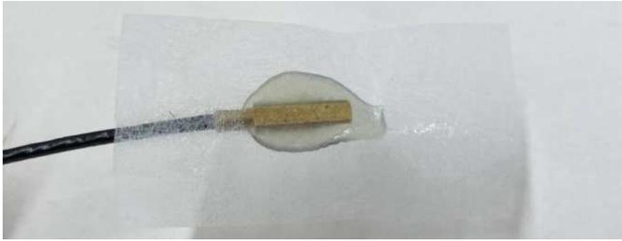
Abb. 8: Sensorkopf mit Heißkleber auf Hollytext befestigt, Unterseite (Kleber geht durch)
