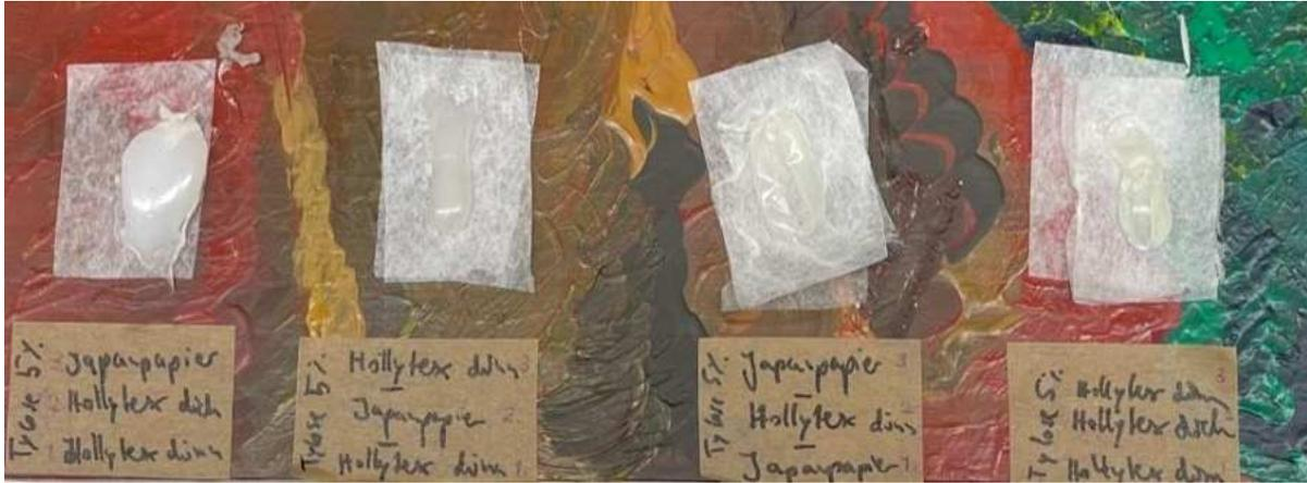
Abb. 2: Probekplatte 3 mit unterschiedlichen Papieren und Geweben und Heißklebertropfen
