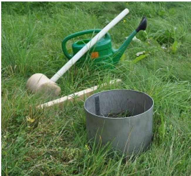
Abbildung 9: Einfachring-Infiltrometer mit innenliegender Skala zum Ablesen des Wasserstandes. Im Hintergrund steht eine Gießkanne zur Befüllung des Infiltrometers sowie ein Hammer und ein Brett zum Einschlagen des Infiltrometers in den Boden
