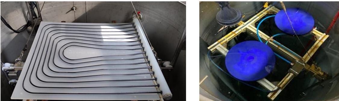
Abbildung 12: Installation des Moduls „MILA – Umlenkung“ (links) und der Tellerbelüfter (rechts) in den DN900 Säulen
