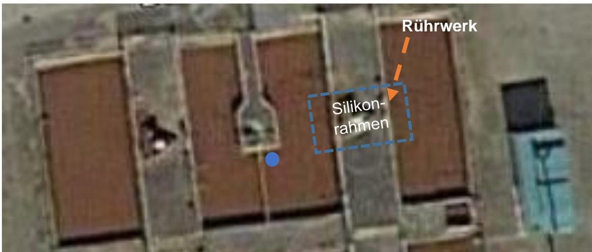
Abbildung 29: Testbecken „Nord“ der Industriekläranlage mit eingesetztem Rahmen (blau gestricheltes Rechteck), mit Standort der Sauerstoffsonde (blauer Punkt) und dem Rührwerk Mitte rechts an der rechten Brücke (orangener Pfeil)- Bildquelle: <https://maps.google.com/>.
