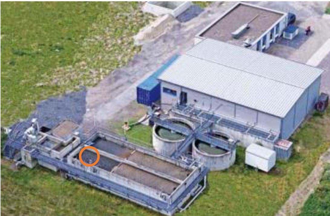
**Abbildung 22: Luftbild der Versuchskläranlage der EGLV auf der Kläranlage „Emschermündung“ mit Einsatzort der Begaserröhrchen im Deni-Becken (orangener Kreis).**
