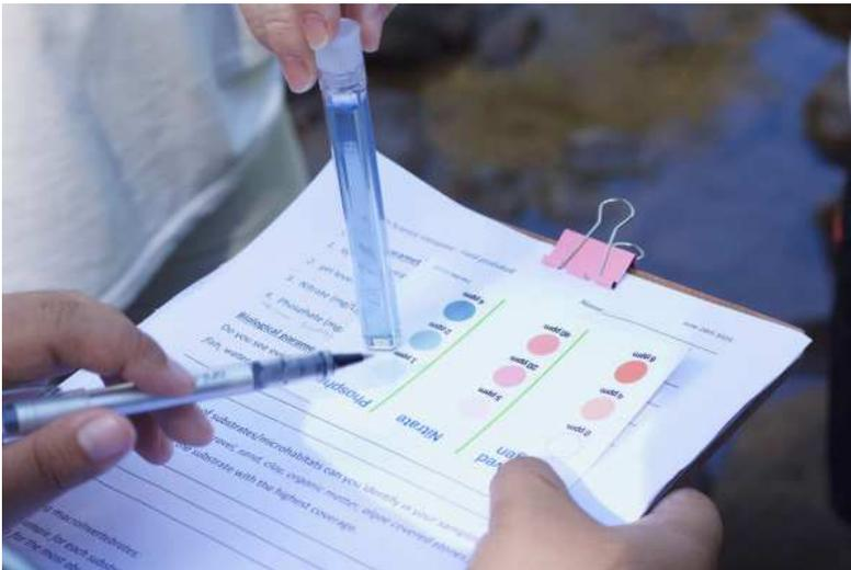
Unsichtbare Verschmutzungen im Wasser können mithilfe von chemischen Tests erkannt werden.
