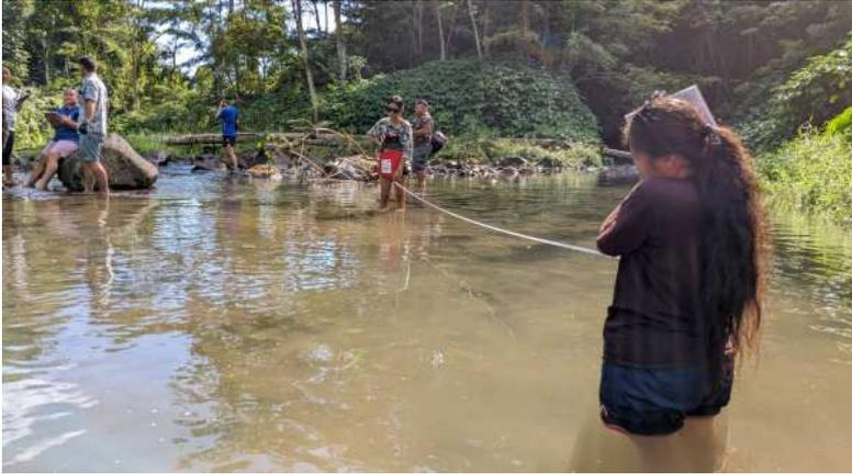
Die Teilnehmenden messen verschiedene Parameter, wie etwa die Fließgeschwindigkeit des Wassers. Dafür benötigt man ein Maßband, eine Stoppuhr und ein schwimmendes Objekt.
