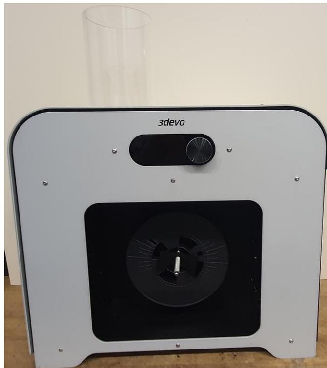
*Abbildung 11: Extruder „Composer 450“ von 3Devo mit Filamentspule im unteren Bildbereich (Foto: Ostfalia)*
