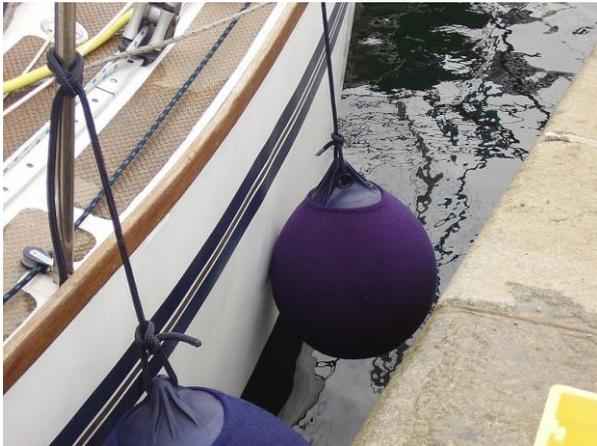
Abbildung 4: Fender zwischen Schiffsrumpf und Hafenummauer
