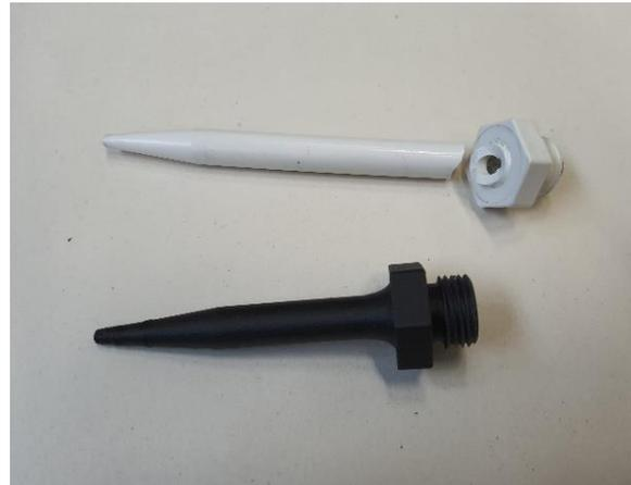
Abbildung 5: oben: gebrochene Originaltülle, darunter: optimiertes 3D-Druck Bauteil
