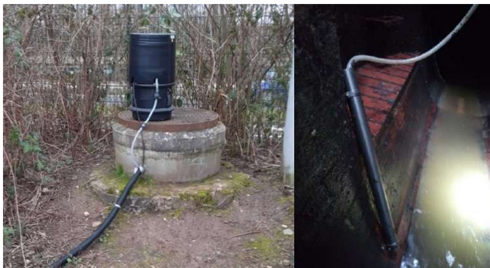
Abbildung 3.3: Automatische Probenehmer (links) und Führung des Probenahmeschlauches über Leerrohre (rechts) ©StEB Köln
