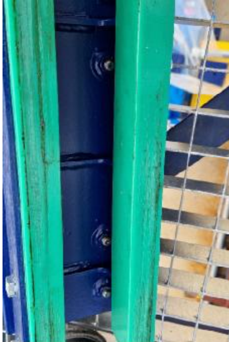
(a) Ausgebaute Gleitkufen Führung
