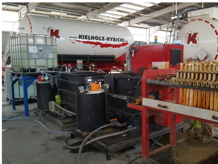
Bild 9: Elektrochemische Schwermetallabscheidung mit vorgeschalteter pH-Neutralisation
