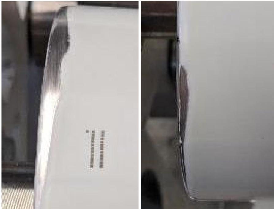
Abbildung 4: Beschichtungsfehler im Randbereich der Zylinder
