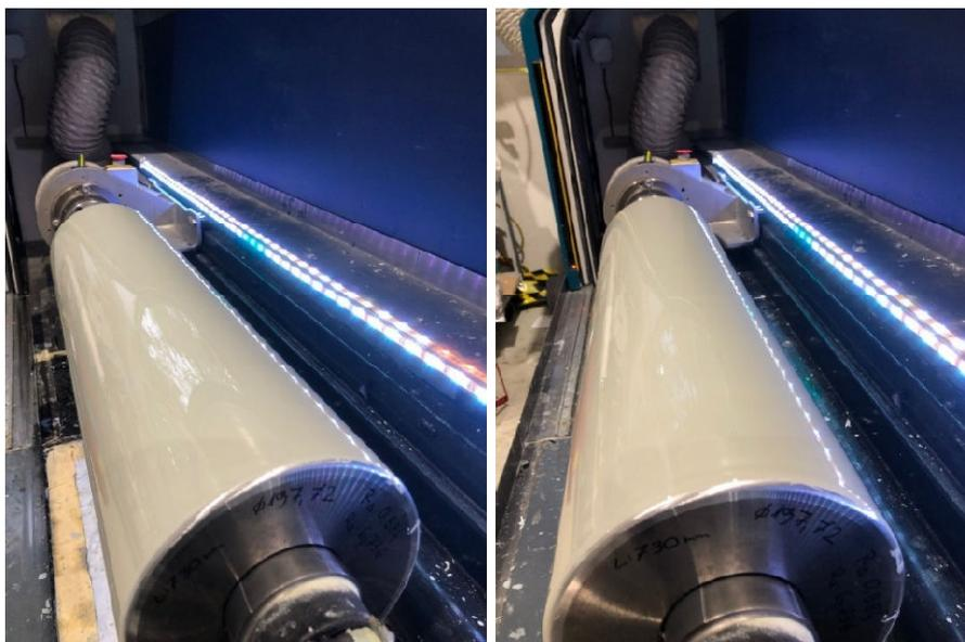
Abbildung 3: Versuche zur Erzeugung der Druckformbeschichtungen
