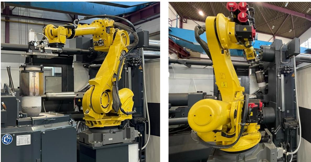
(Abbildung 9: Exakte Dosierung der Schmelzmenge mittels Roboterführung)
