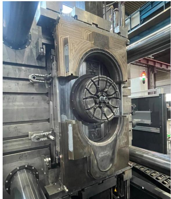
(Abbildung 10 und 11: Umgesetzte Anbaulösung der Aufspannplatten – feste und bewegliche Seite)
