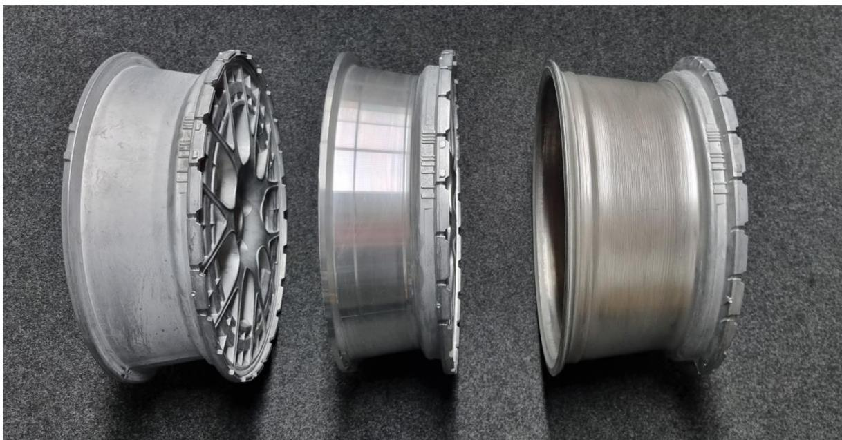
(Abbildung 17: Vergleich Gussteil – vorgedreht zum Auswalzen – Ergebnis nach dem Flowforming)
