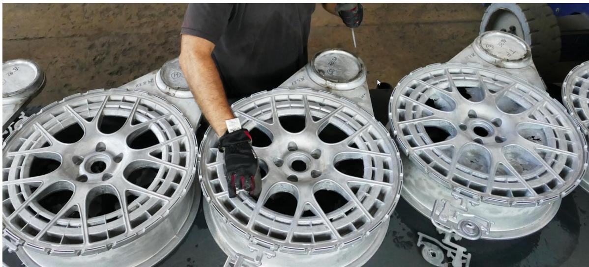
(Abbildung 14: Gießergebnisse mit optimierter Aufspannplatten und verbessertem Werkzeug)
