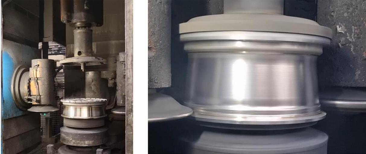
(Abbildung 18 und 19: Der Flowformingprozess – mit Walzen wird die Felge in die Zielbreite verformt)
