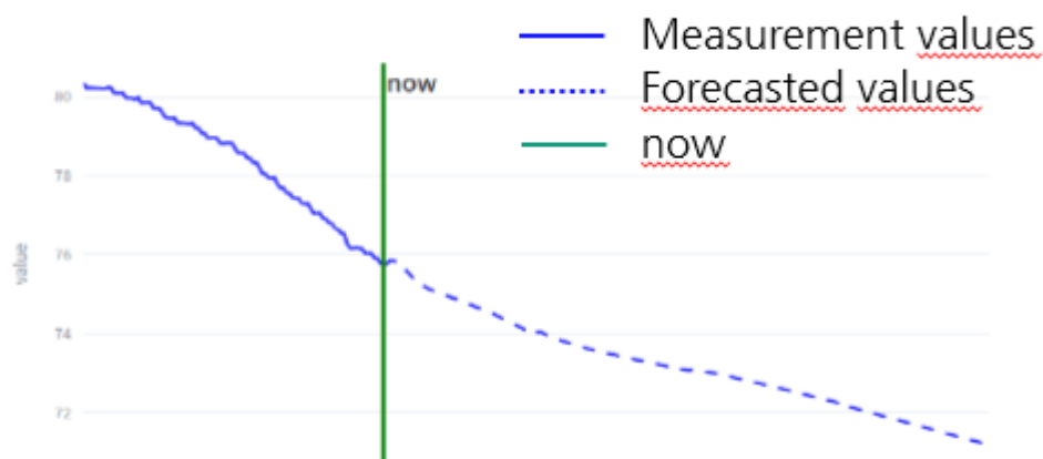
Abbildung 45: Darstellung der erfassten Daten und der daraus generierten Zeitreihenvorhersage. Auf der x-Achse ist die Zeit und auf der y-Achse die Temperatur aufgetragen.
