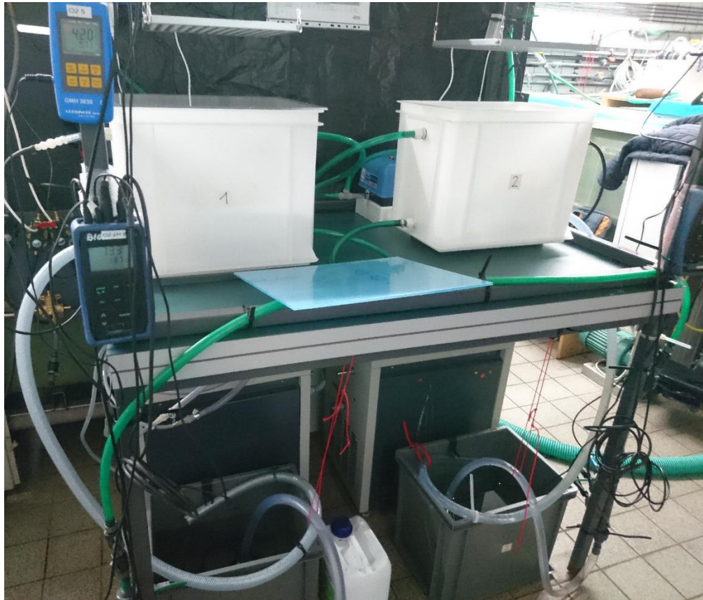
Abb. 5: Laboranlage Hydroponik - Unten: Nährlösungsbehälter, Mitte: Pflanzenbehälter, Oben: LED-Lampen zur Beleuchtung.
