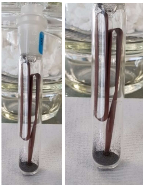
Abbildung 5: Aufbau nach 3 (Tabelle 3) für das Aussetzen von Sorbenzien an Emissionen aus einem natürlich gealtertem Celluloseacetat-Tonband. Das Endstück des Tonbands steckt in einem (im Bild schwer erkennbaren) Mikroeinsatz. © C. Mazzon.
