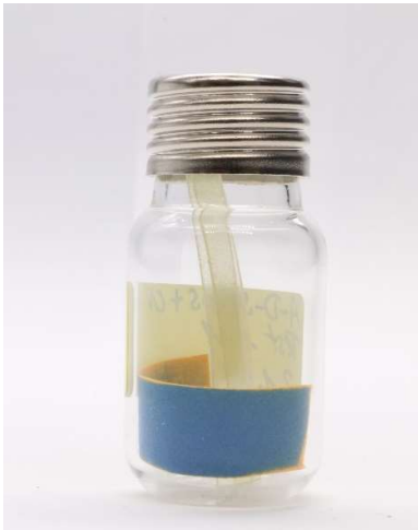
Abbildung 3: Nach einem Tag mit dem CN-Material (senkrechter Streifen) im geschlossenen Gefäß wechselt die Farbe des A-D Strip von blau nach gelb (gelbe Farbe sichtbar auf der inneren Seite des Streifens, welcher waagrecht auf dem Gefäßboden liegt) © C. Mally.
