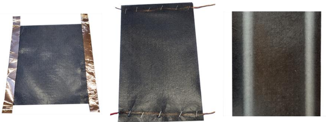
Abbildung 5.1: Mögliche Kontaktierungsvarianten der rCF-basierten Heizelemente mittels Kupferklebeband (links), Kupfergarn (Mitte) und aufgedampften Metallpartikeln (rechts)
