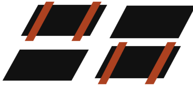
Abbildung 5.2: Variation der Position der Kontaktierung oben (links) oder mittig (rechts)
