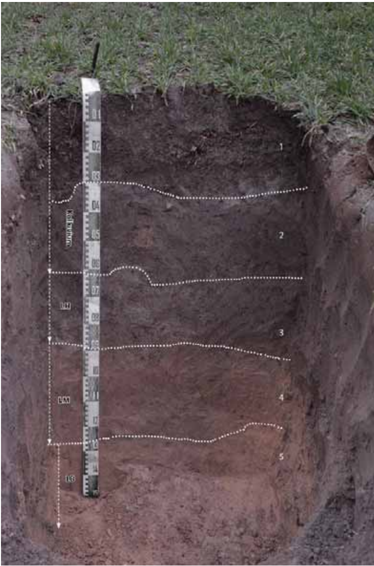
Abb. 34 Standort 22: Kitzten - Profilfoto Kolluvisol über Braunerde-Tschernosem aus Löss LH: Hauptlage, LM: Mittellage, LB: Basislage (Foto: F. Hieke)
