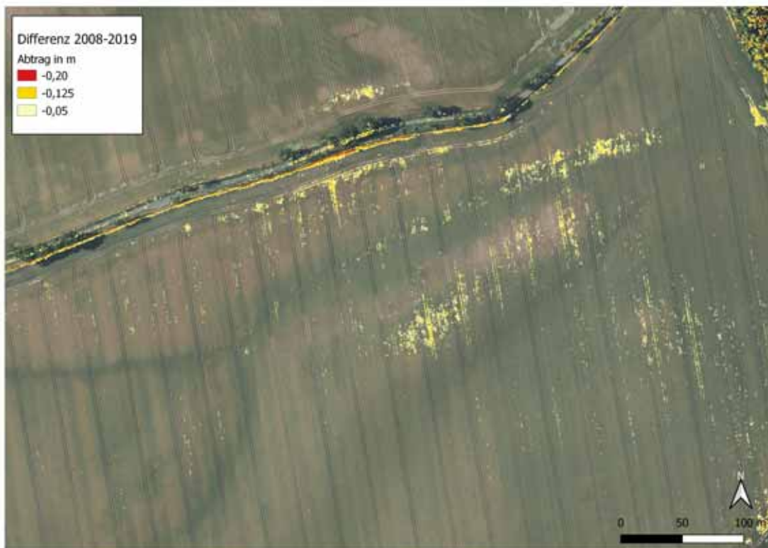
Abb. 101 Bereiche mit Abtrag von mehr als 0.1 m. Überlagerung mit Orthofoto für den Vergleich mit sichtbar erodiertem Oberboden.
