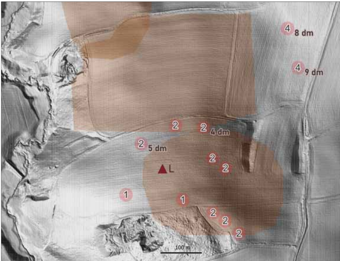
Abb. 53 Die Erosionsgrade nach KA5 und Aufträge (dm) im Gebiet Noßwitz lt. Feldbefunden.
