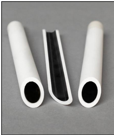
Abbildung 4: Innenseitig beschichtete Einkanalrohre mit einer Kohlenstoffschicht.
