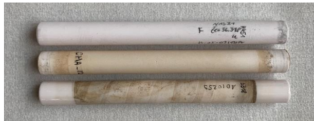
Abbildung 17: Molsiebmembranen (v. o. n. u. NaA, Chabasit und SAPO in 105-mm Rohrgeometrie) vom IKTS für Tests am DBI.
