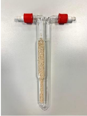
Abbildung 38: Behälter mit Molsieb zum Auffangen des durch die Membran getretenen Wassers.
