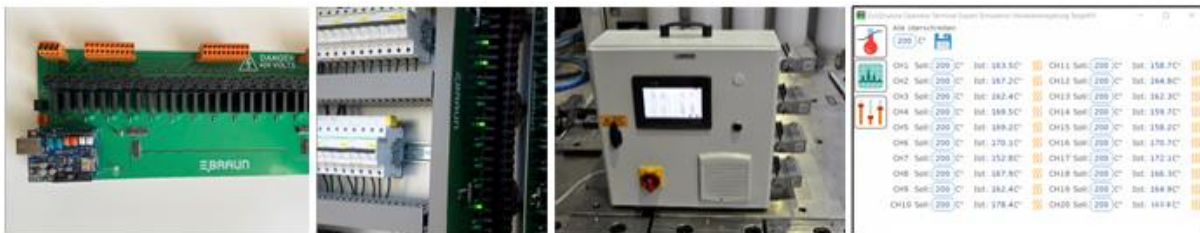
Abbildung 11 - Steuerung und Bedieneinheit für elektrische Heizeinsätze
