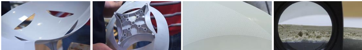
Abbildung 16 - erreichte Bauteilqualität Formteil Deko-Schale; ganz rechts: erstarrte Randschicht und Poren in Vergrößerung
