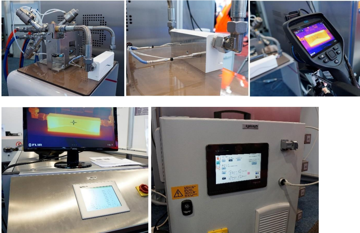
Abbildung 12 - Funktionstest an einem genuteten Einsatz mit elektrischer Beheizung in Kombination mit eine Wasser-Wechseltemperierung
