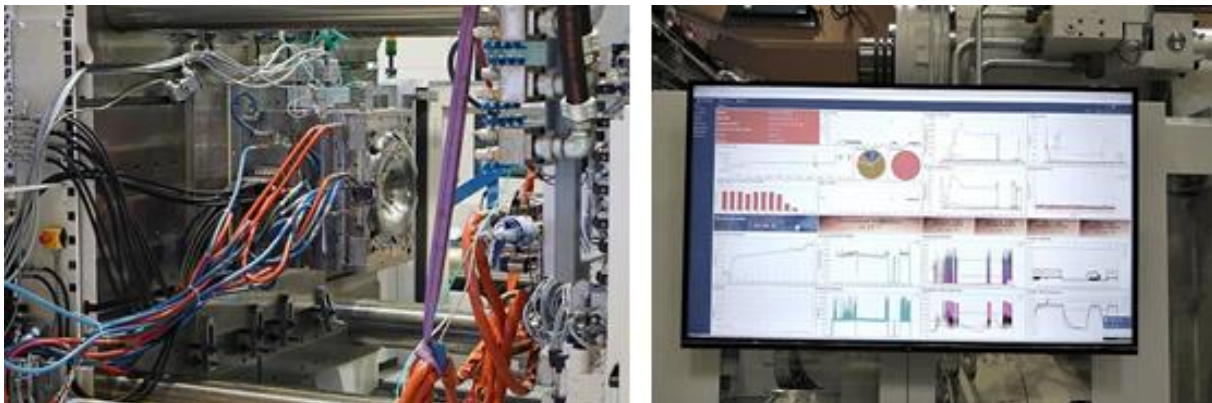
Abbildung 17 - Im Werkzeug verbaute Sensorik und Monitoring im Spritzgusszyklus
