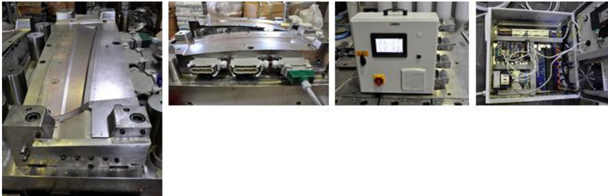
Abbildung 14 - Elektrische Heizstäbe - Steuerung über einzelne Thermoelemente in den Heizstäben oder über Thermoelemente in der Fläche möglich - Funktionstests
