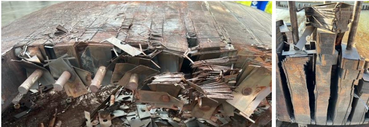
Abb. 17: Fotodokumentation der Generatorzerlegung am Standort Baudenbach 3 links: Rotoroberfläche mit Trafoblechen und SE-Magneten rechts: Statorwand
