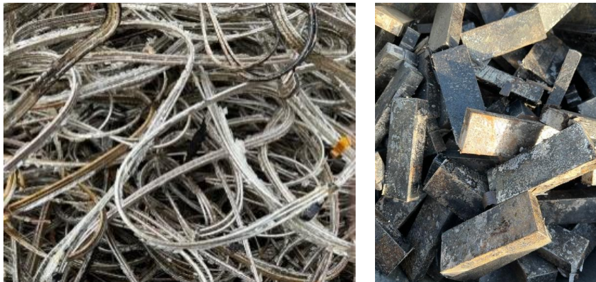
Abb. 18: Fotodokumentation der Generatorzerlegung am Standort Baudenbach 4 links: Produktqualität Cu-Wicklungen rechts: Produktqualität SE-Magnete
