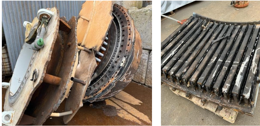
Abb. 16: Fotodokumentation der Generatorzerlegung am Standort Baudenbach 2 links: Stahlteile mit Rotorelement rechts: Statorwand
