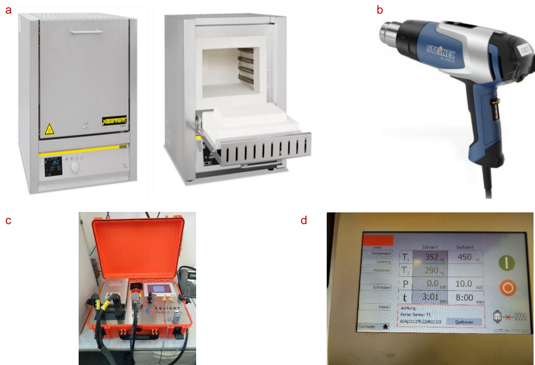
Abb. 10: Versuchstechnik zur Entmagnetisierung der WEA-Magnete [Quellen: Firmenprospekte] a) Muffelofen L15/13/C450, Fa. Nabertherm/Bremen; b) Heißluftgebläse HL 2020 E mit digitaler Temperaturanzeige, Fa. Steinel/Herzbrock; c+d) Lokale Entmagnetisierung mittels MFG LIK 10-400, Fa. Leifert/Oldenburg)
