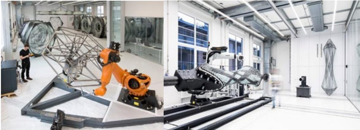
Abbildung 3: Beispielhafte Darstellung des Wickelverfahrens für Faserverbundsysteme für die realisierten Projekte Elytra Filament Pavillon, V&A Engineering Season 2016 am Victoria and Albert Museum London (links) und BUGA Faserpavillon 2019 für die Bundesgartenschau Heilbronn (rechts)
