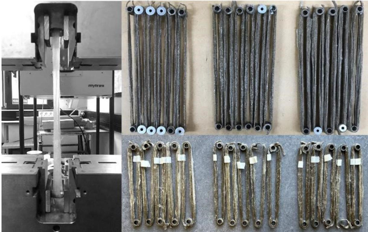
Abbildung 15: Versuchsordnung für die kleinmaßstäblichen Versuche (links). Schlaufenförmige Probekörper, die auf Zug beansprucht (rechts oben) oder auf Druck belastet werden (rechts unten)
