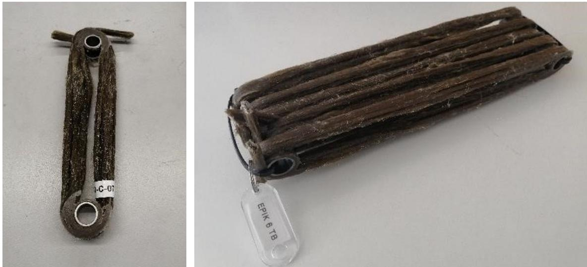
Abbildung 20: Einzelner Probekörper (links) und Specimen-Bündel (rechts). 5 Probekörper derselben Baureihe wurden jeweils zu einem Bündel zusammengefasst, hier Hexion Epikote (EPIK), nach 6 Monaten aus dem Prüfstand entnommen und in der Prüfmaschine einzeln auf Zugbelastung getestet (TB = Tension – Batch B)
