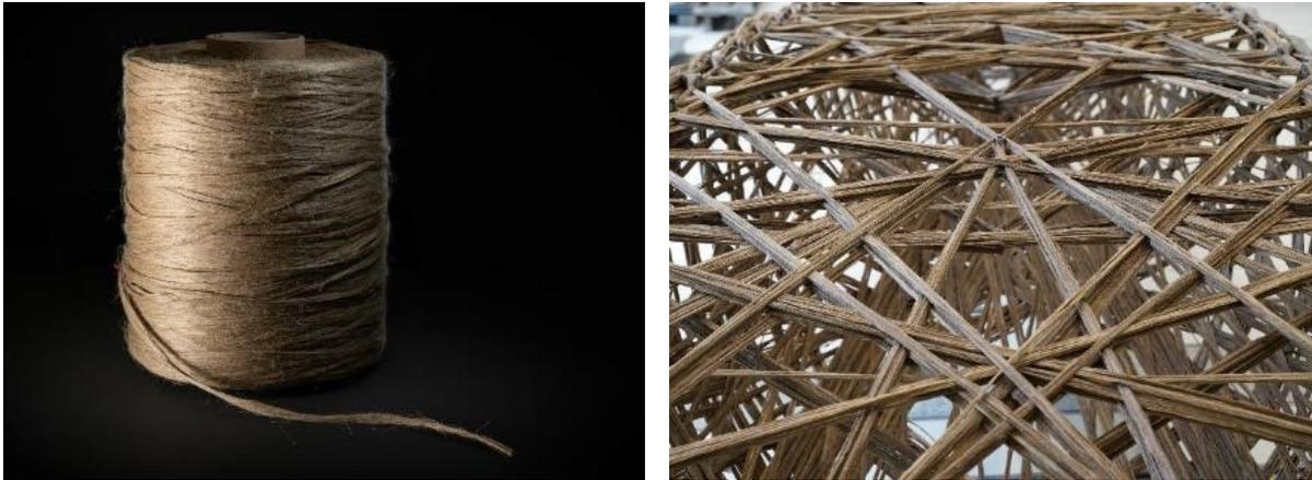
Abbildung 5: Flachsfaserspule (links), Wickeldetail eines Naturfaser-Bauteils (rechts)
