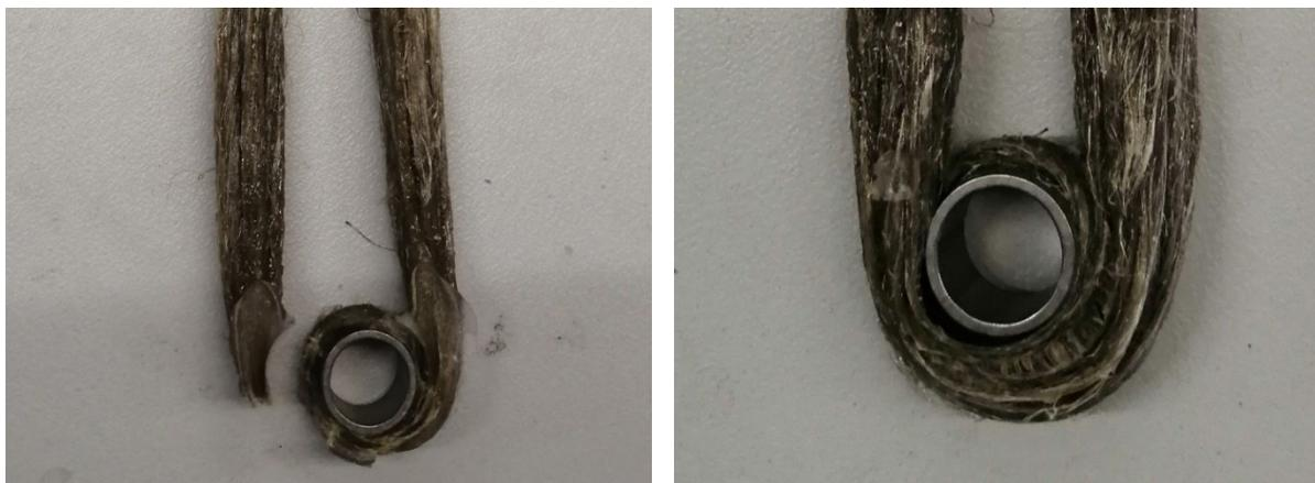
Abbildung 29: Typische Versagensart bei Zugbelastung (Greenpoxy, 6 Monate, links) und Delaminierung des auf Druck beanspruchten Probekörpers an der Hülse (Hexion Epikur, 12 Monate, rechts)
