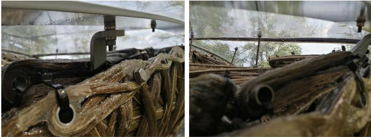
Abbildung 22: Die Probekörper-Bündel wurden unter der Dachkonstruktion des livMatS Pavillons für die Dauer der Messungen fixiert
