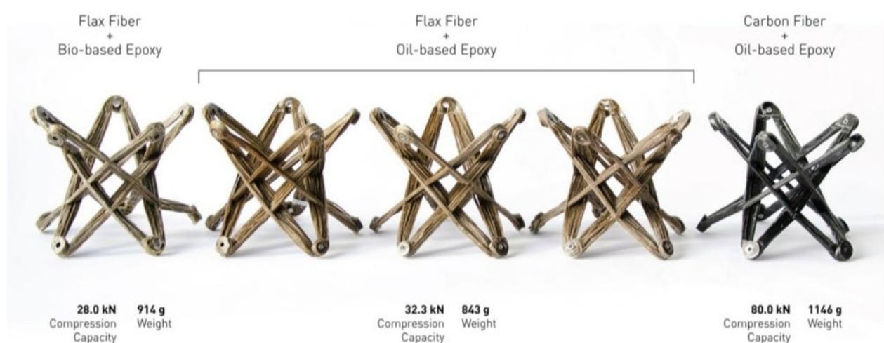
Abbildung 13: Probekörper für Vorversuche zur Tragfähigkeit in verschiedenen Faser-/Harz-Kombinationen: Flachsfasern mit biobasiertem Epoxidharz (links), Flachsfasern mit erdölbasiertem Epoxidharz (drei Probekörper in der Mitte), Kohlenstofffasern mit erdölbasiertem Epoxidharz (rechts)
