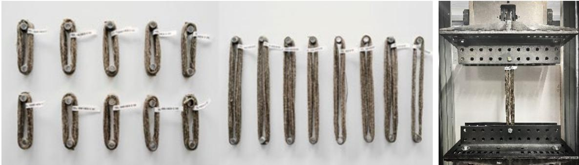
Abbildung 26: Testprobekörper für Druckbeanspruchung (links), Testprobekörper für Zugbeanspruchung (Mitte), Prüfaufbau auf Zwick Roel Z100 (rechts)
