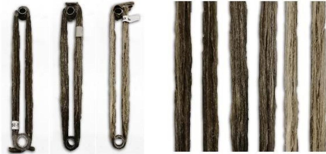
Abbildung 34: Ausbleichen der Faserprobekörper nach 0, 6 und 12 Monaten am Beispiel der Probekörperreihe Greenpoxy Tension
